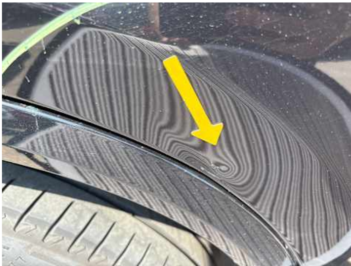
Türe hinten rechts (Verformung, Delle, Kratzer)
