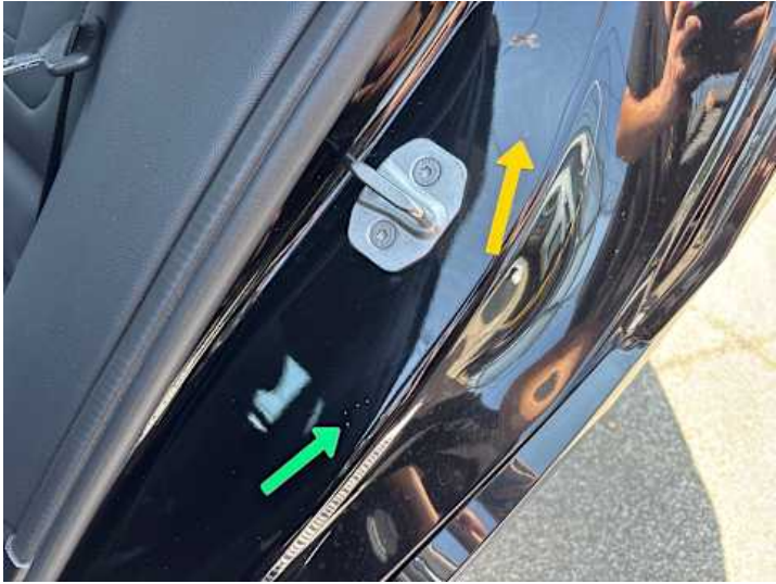
Seitenteil hinten links (Lackschaden, Kratzer)
