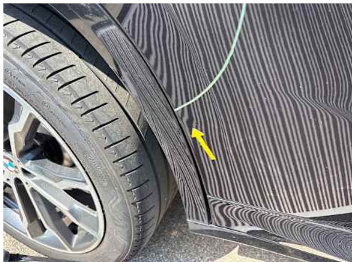
Türe hinten rechts (Verformung, Delle, Kratzer)
