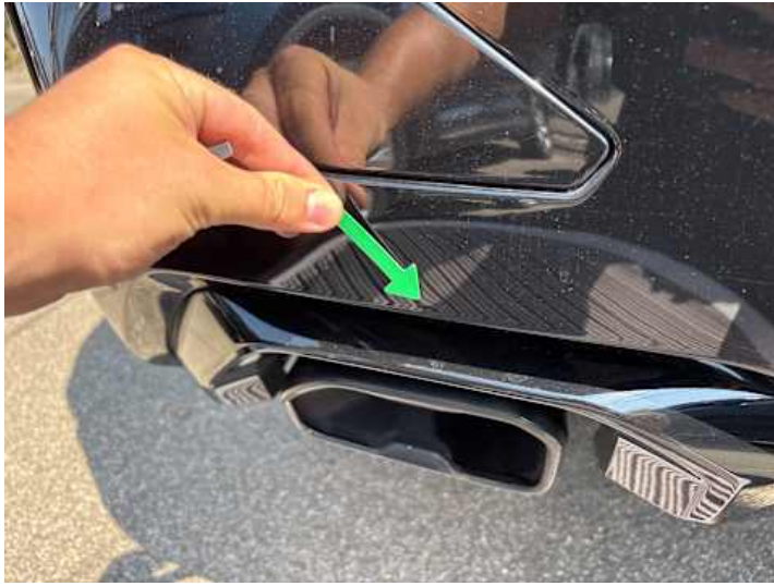
Stoßstange hinten (Verformung, Lackschaden)
