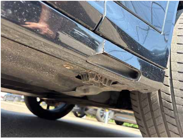
Schweller rechts (Lackschaden, Riss/Bruch)
