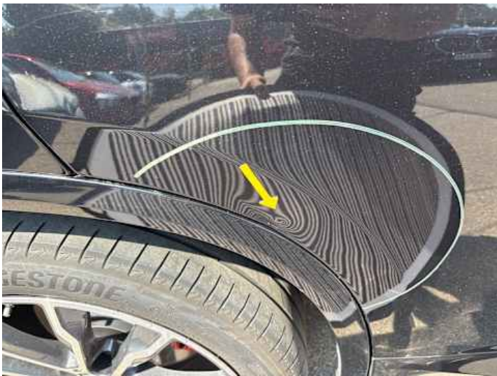
Türe hinten rechts (Verformung, Delle, Kratzer)
