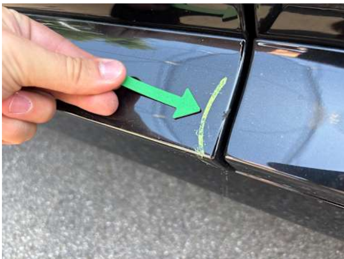
Fahrtür (Kratzer, Lackschaden)
