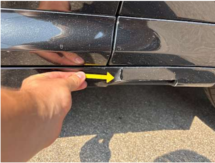
Schweller rechts (Lackschaden, Riss/Bruch)
