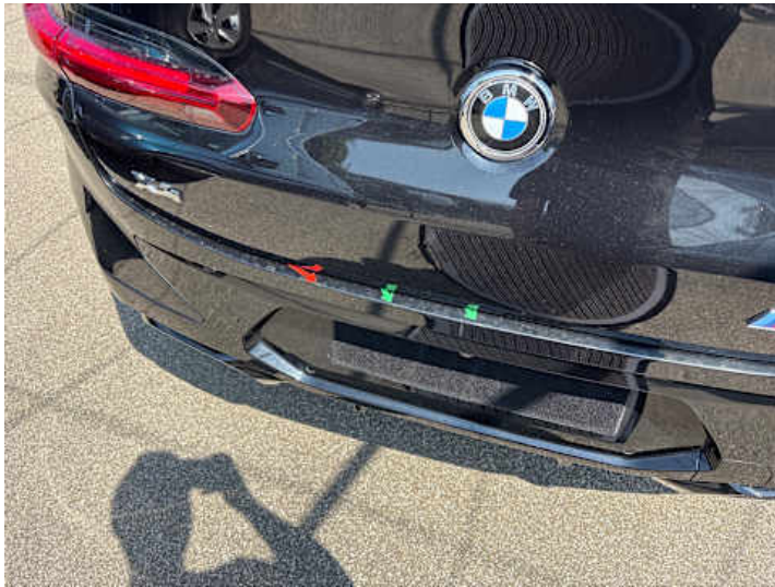
Stoßstange hinten (Kratzer, Lackschaden)
