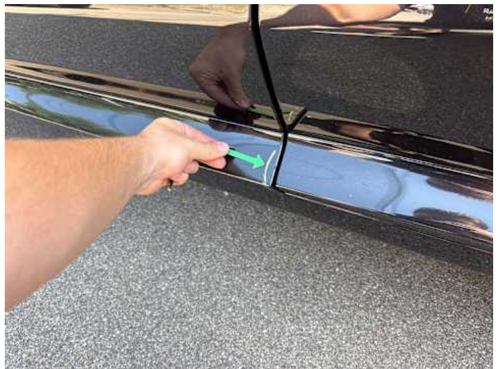
Fahrtür (Kratzer, Lackschaden)
