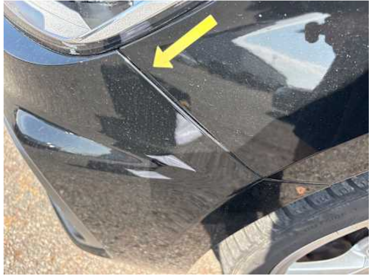
Stoßstange vorne (Spaltmaße ungenau)
