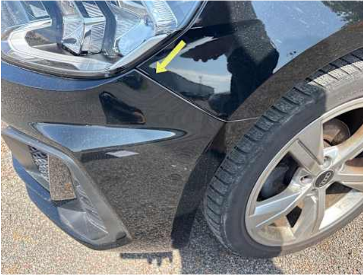
Stoßstange vorne (Spaltmaße ungenau)
