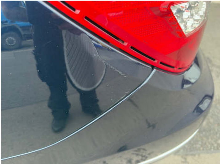
Seitenteil hinten links (Lackschaden)
