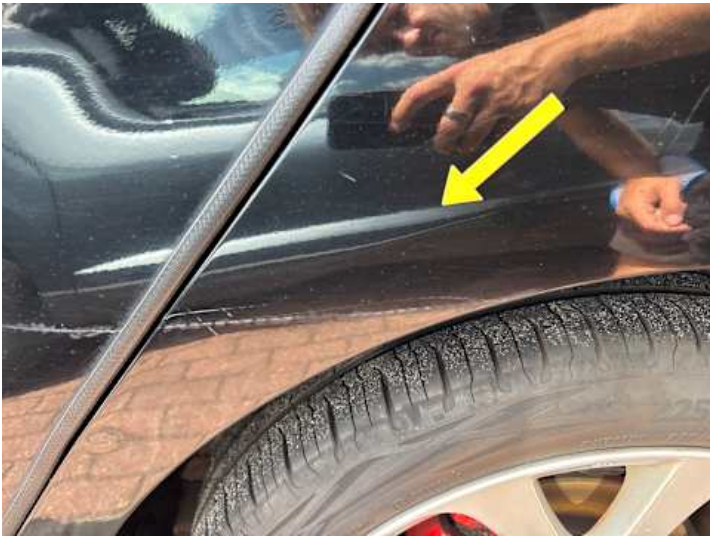
Seitenteil hinten links (Kratzer, Delle)
