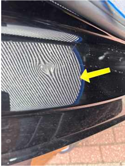
Schweller rechts (Delle, Kratzer)
