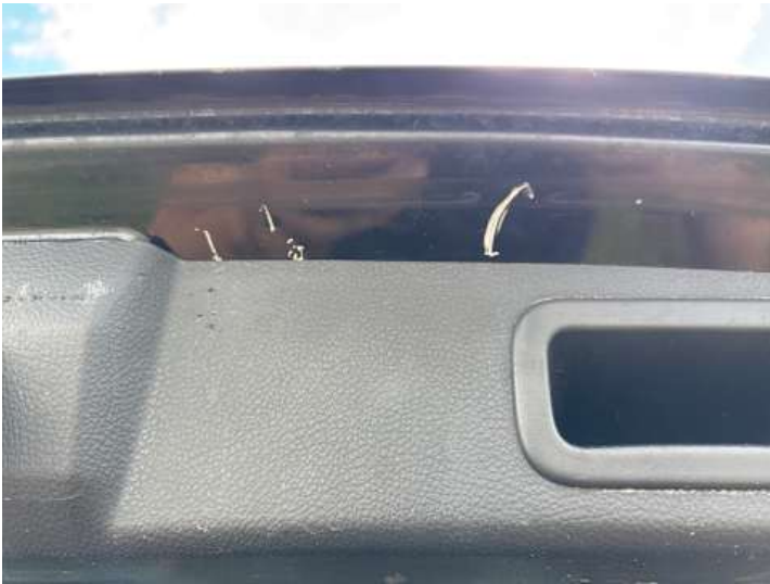
Heckklappe (Kratzer, Lackschaden)
