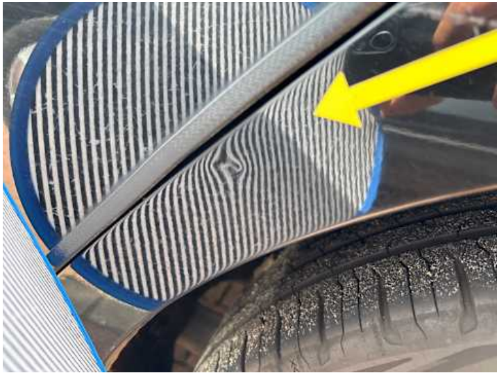
Seitenteil hinten links (Kratzer, Delle)
