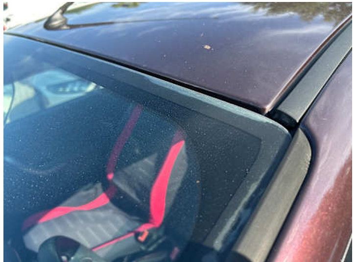
Windschutzscheibe (Anderer Schaden): Ablösung
