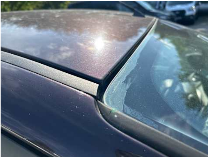
Windschutzscheibe (Anderer Schaden): Ablösung
