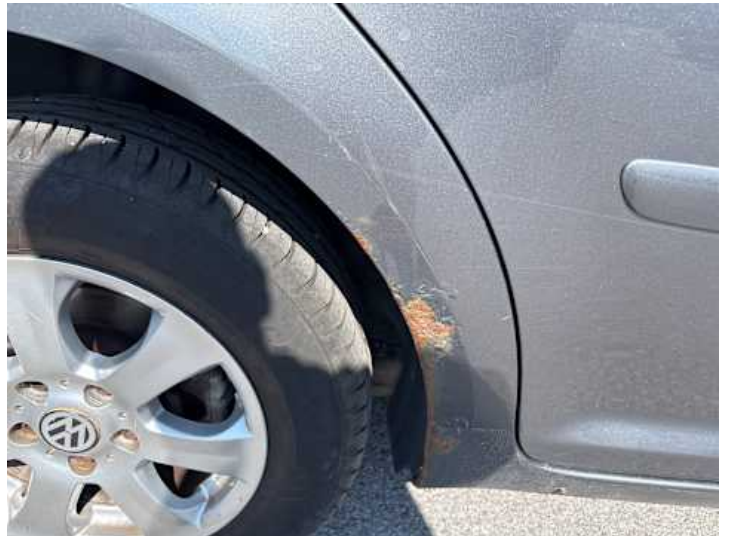
Seitenteil hinten rechts (Rost)
