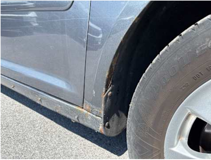
Kotflügel vorne rechts (Rost)
