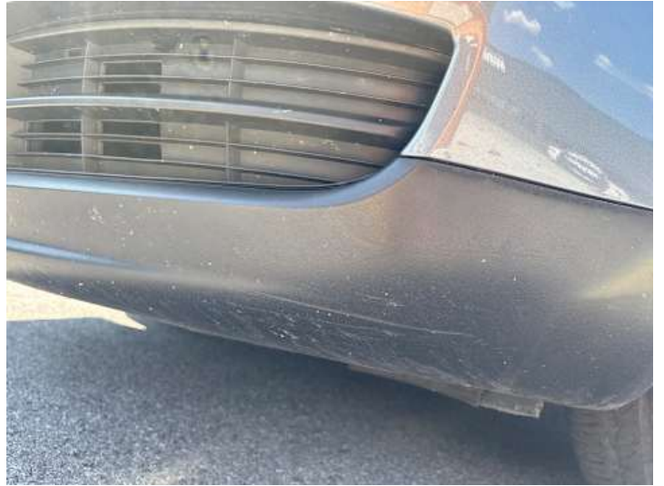
Stoßstange vorne (Kratzer, Spaltmaße ungenau)
