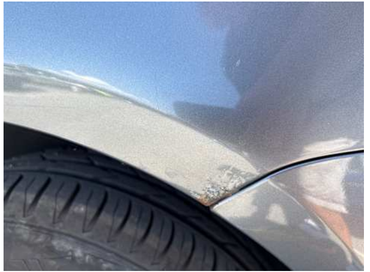
Seitenteil hinten links (Rost)
