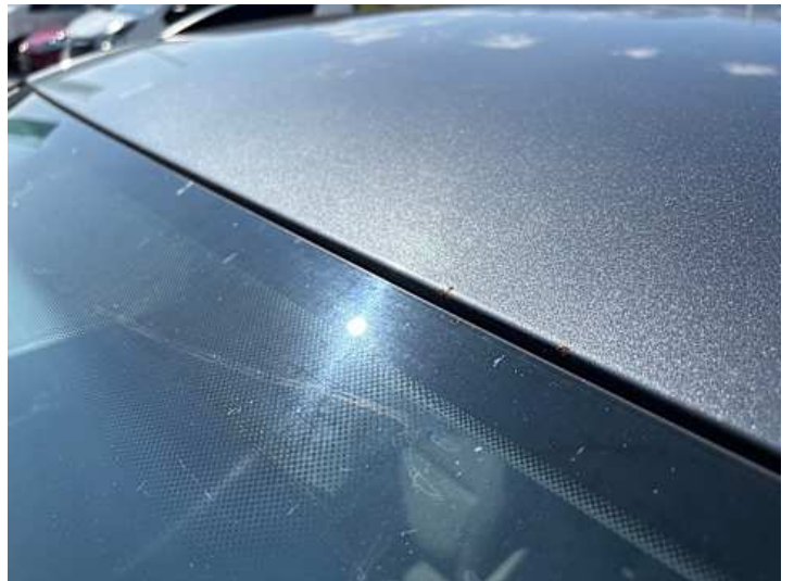
Dach (Steinschlag, Rost)
