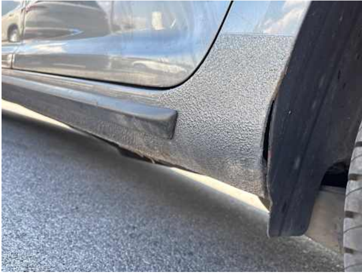
Schweller links (Rost, Verformung)
