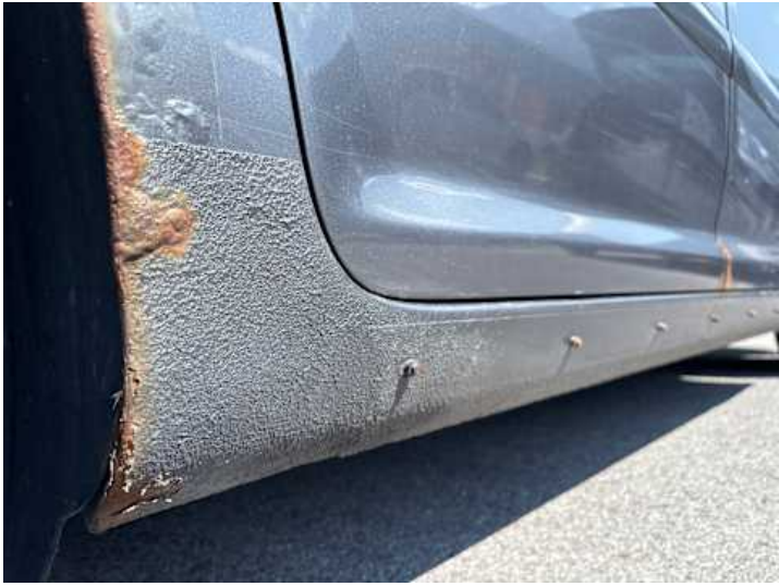
Schweller rechts (Rost, Unsachgemäß instand gesetzt)
