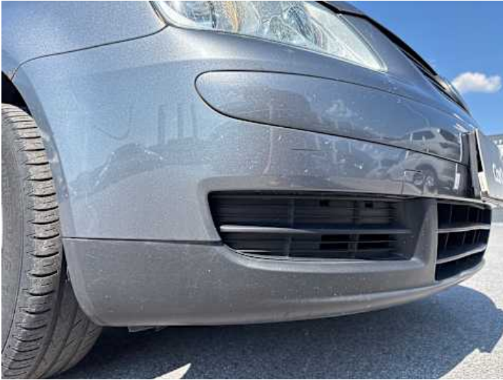
Stoßstange vorne (Kratzer, Spaltmaße ungenau)
