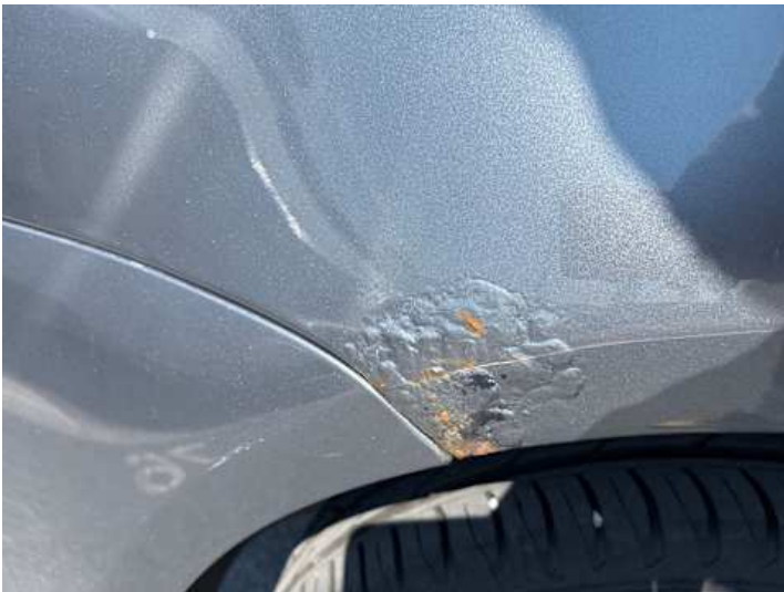
Seitenteil hinten rechts (Rost)
