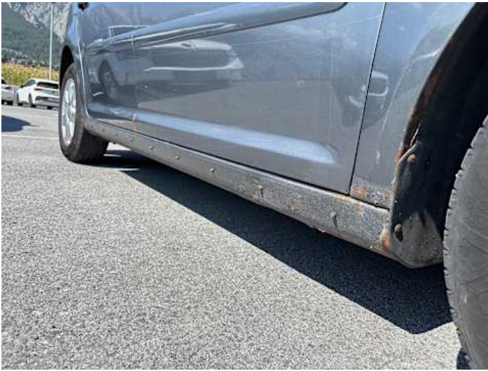
Schweller rechts (Rost, Unsachgemäß instand gesetzt)
