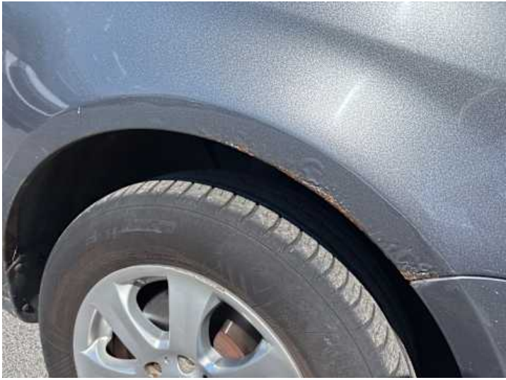
Kotflügel vorne rechts (Rost)
