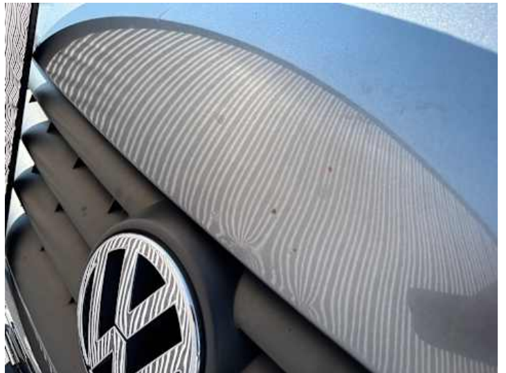
Motorhaube (Verformung, Steinschlag, Rost)
