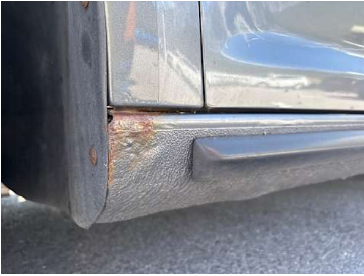
Schweller links (Rost, Verformung)
