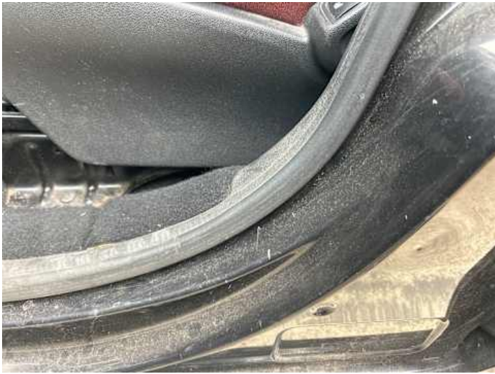
Schweller links (Kratzer)
