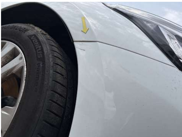
Stoßstange vorne (Spaltmaße ungenau)
