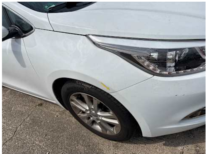
Stoßstange vorne (Spaltmaße ungenau)
