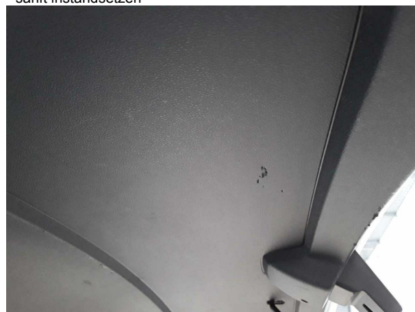
Beschädigung #8: Verkleidungen/Abdeckungen: Heckdeckel, Innenverkleidung - verkratzt / verschürft - erneuern
