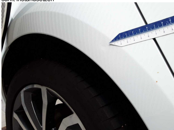
Beschädigung #7: Seitenwand rechts: Seitenwand - Delle(n) - sanft instandsetzen
