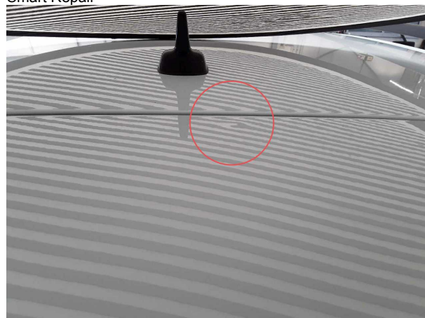
Beschädigung #5: Heckklappe/-tür: Heckklappe (2x) - Delle(n) - sanft instandsetzen
