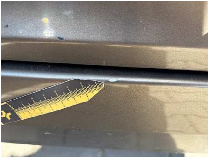
Schweller rechts (Kratzer)
