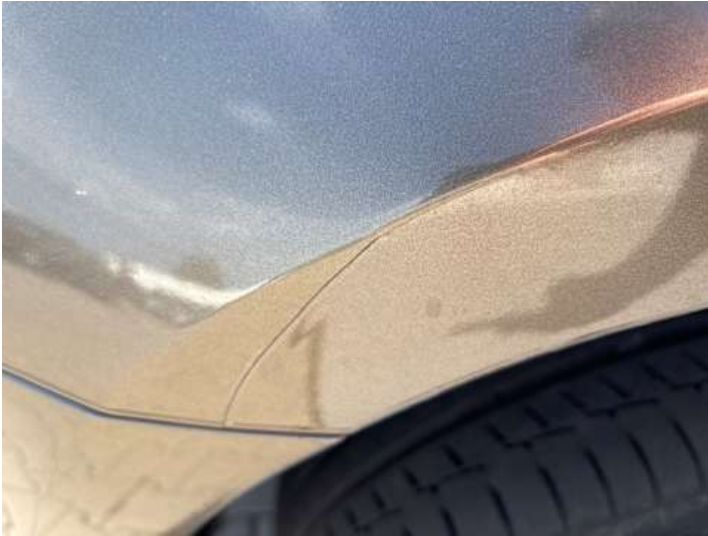
Kotflügel vorne links (Lackschaden)
