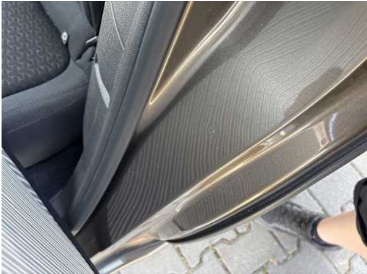
Seitenteil hinten links (Kratzer, Delle)
