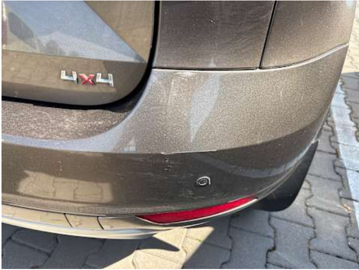
Stoßstange hinten (Kratzer)
