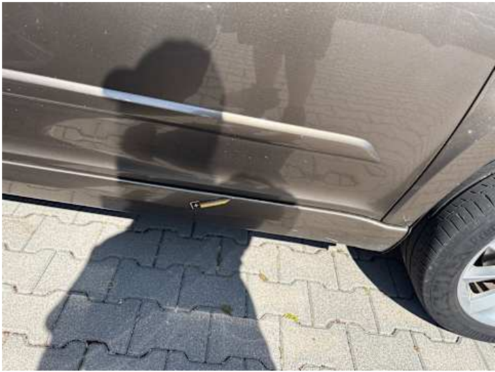
Schweller rechts (Kratzer)
