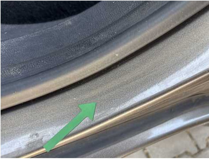
Schweller links (Kratzer)
