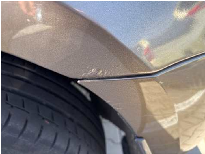
Seitenteil hinten links (Rost)
