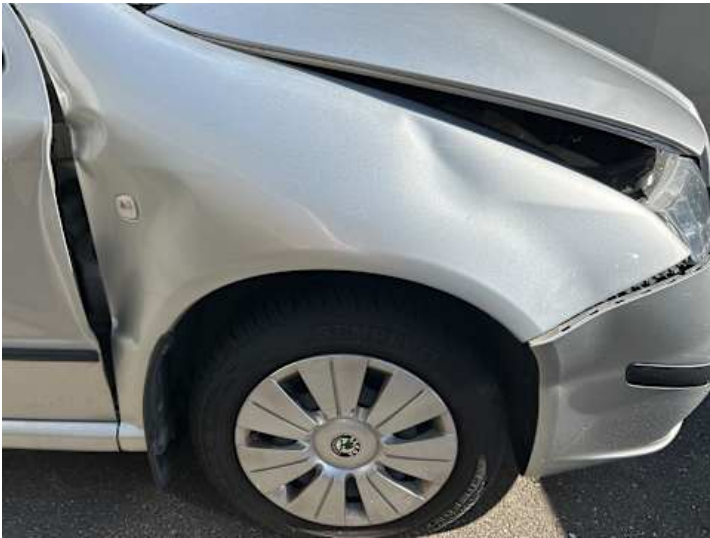
Kotflügel vorne rechts (Verformung)
