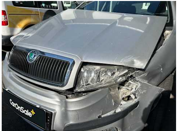
Motorhaube (Verformung, Lackschaden)
