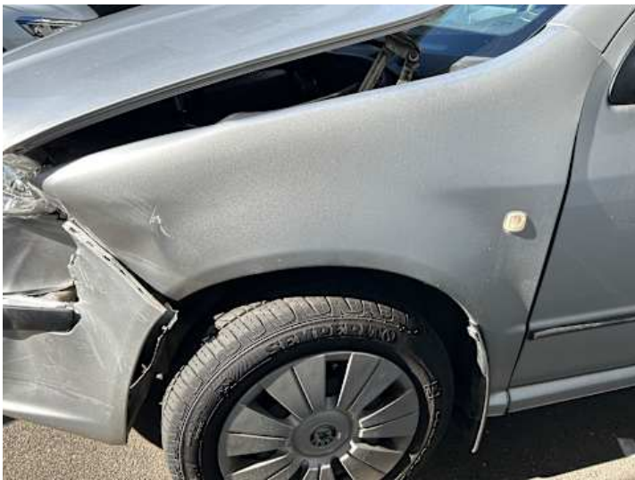
Kotflügel vorne links (Verformung)
