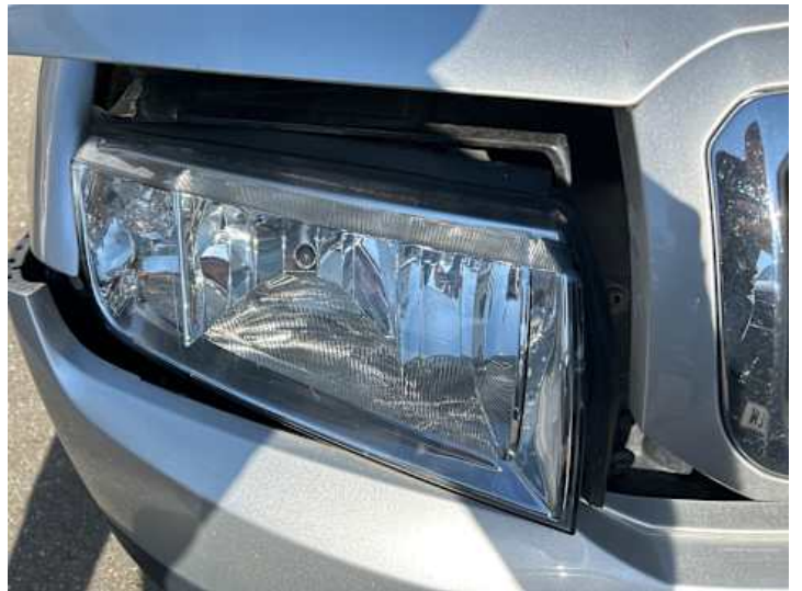
Scheinwerfer (rechts) (Riss/Bruch)
