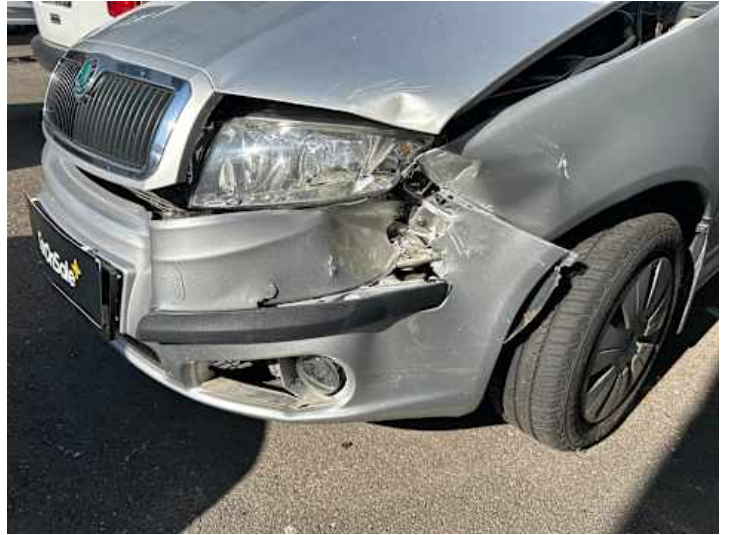
Stoßstange vorne (Riss/Bruch, Lackschaden, Verformung)
