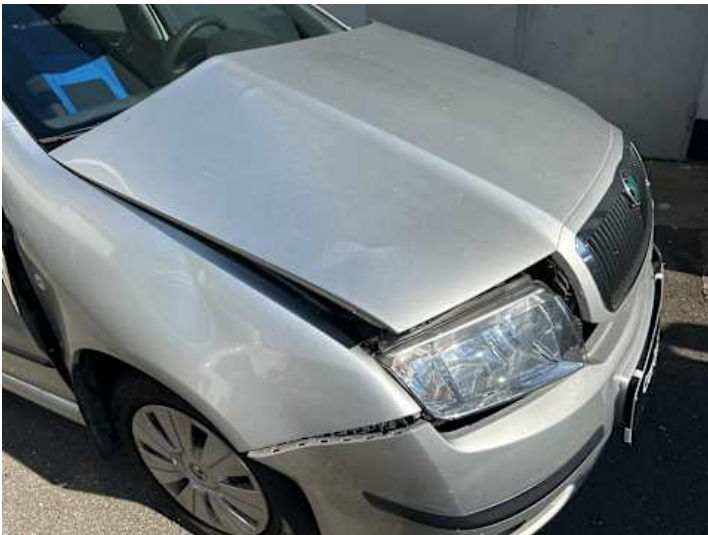
Motorhaube (Verformung, Lackschaden)
