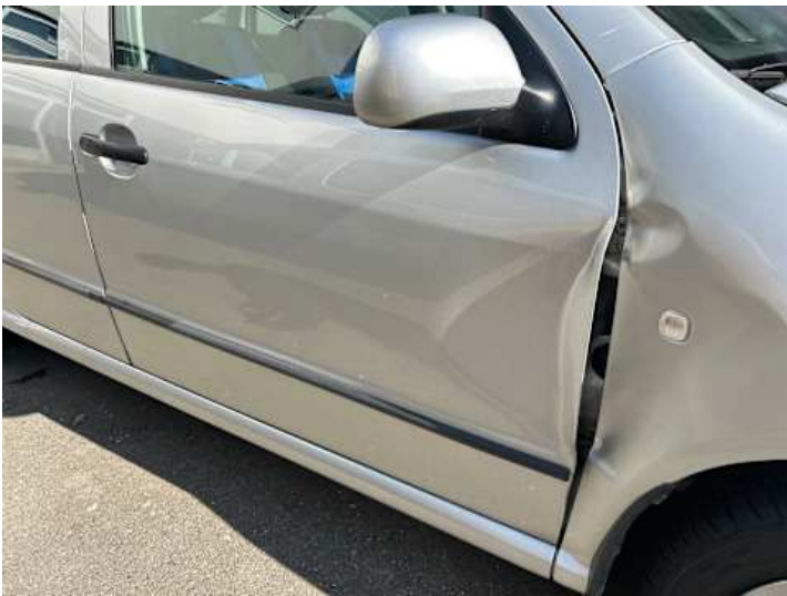
Beifahrertür (Verformung, Lackschaden)
