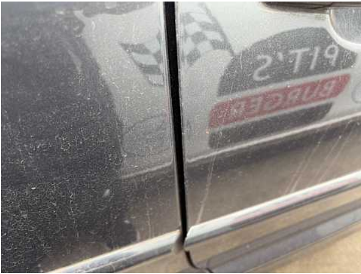
Beifahrertür (Lackschaden, Kratzer)
