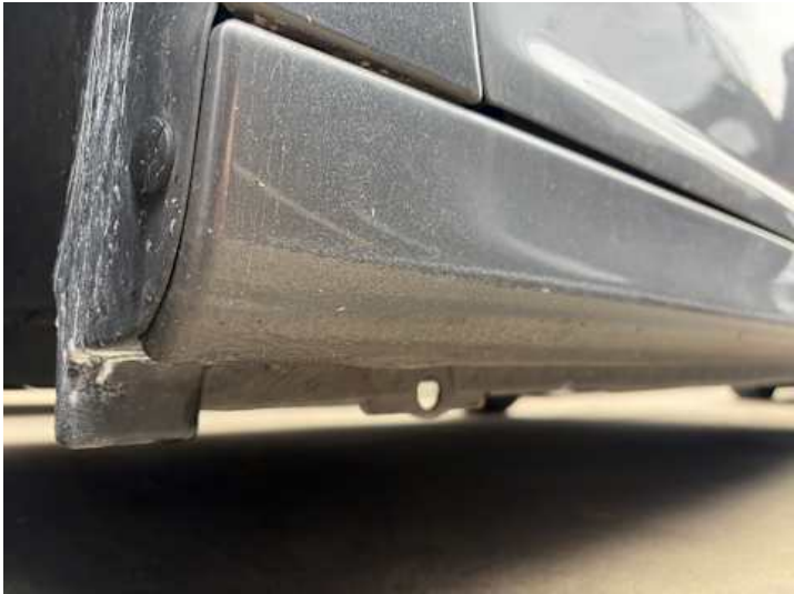
Schweller links (Verformung)
