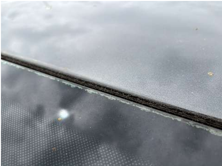
Dach (Lackschaden, Steinschlag)
