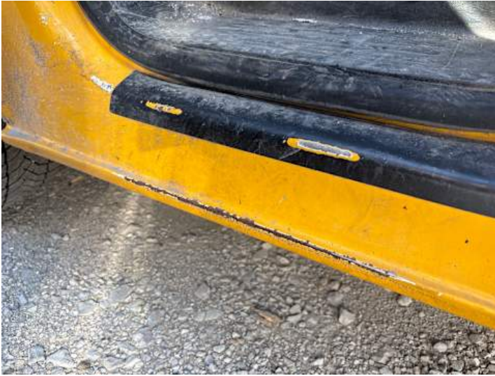
Schweller links (Kratzer, Lackschaden)
