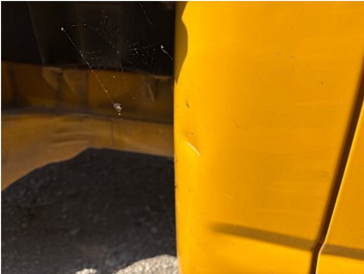
Seitenteil hinten rechts (Verformung)
