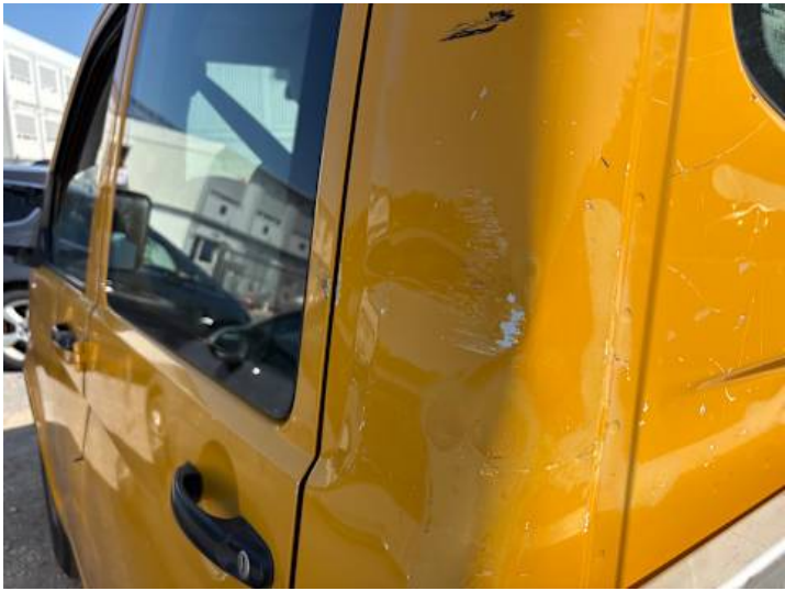
Seitenteil hinten links (Verformung, Lackschaden)
