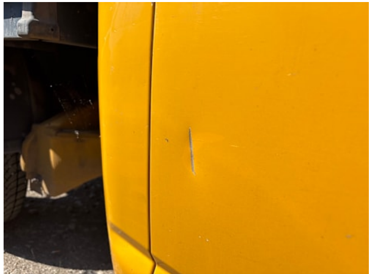
Türe hinten rechts (Kratzer, Verformung)
