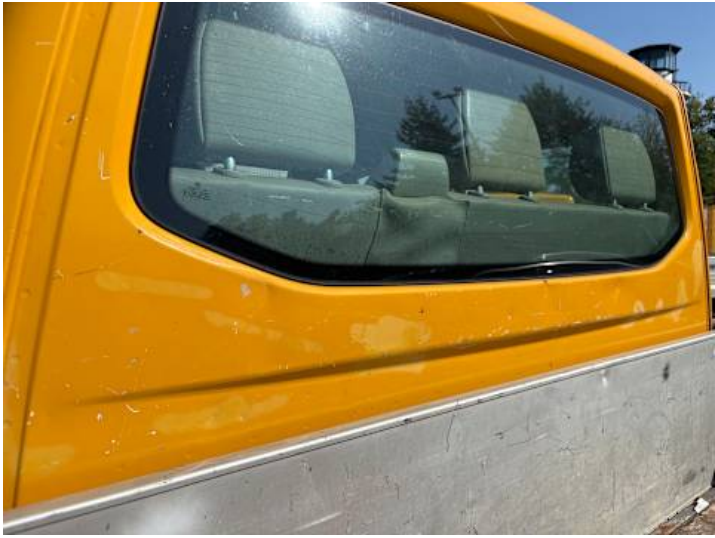
Seitenteil hinten links (Verformung, Lackschaden)
