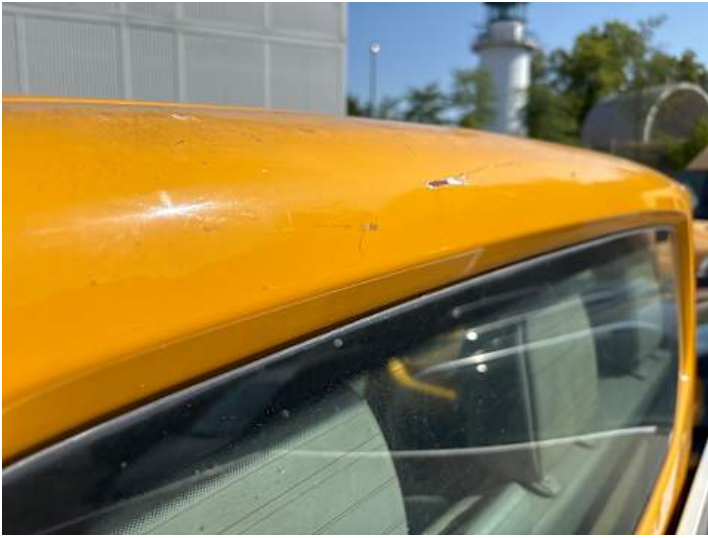
Seitenteil hinten links (Verformung, Lackschaden)
