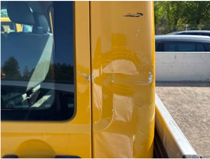
Seitenteil hinten links (Verformung, Lackschaden)
