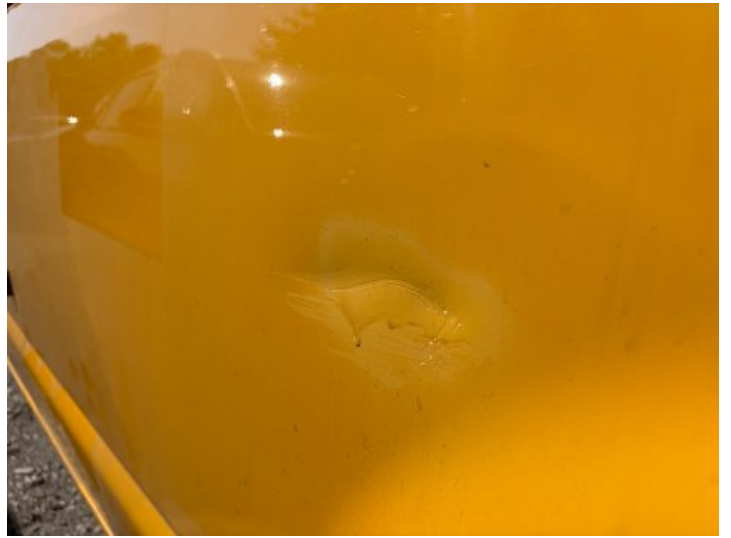
Beifahrer­tür (Verformung, Lackscha­den)
