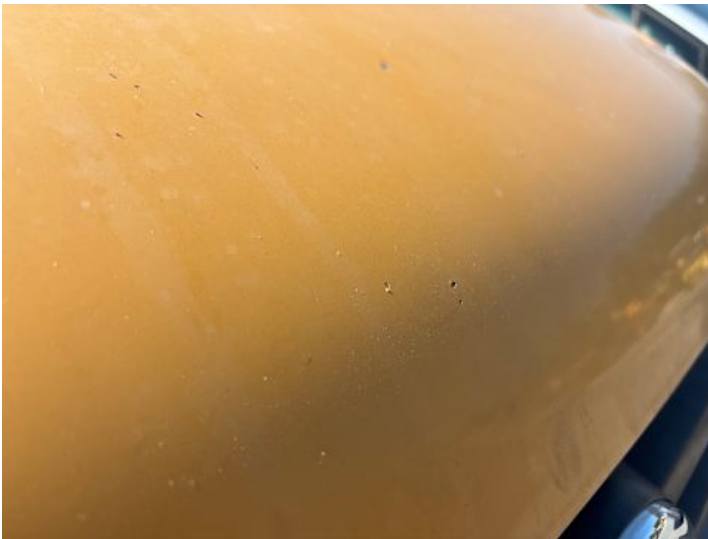
Motorhaube (Rost, Steinschlag)
