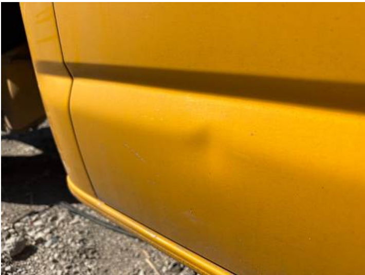
Türe hinten rechts (Kratzer, Verformung)
