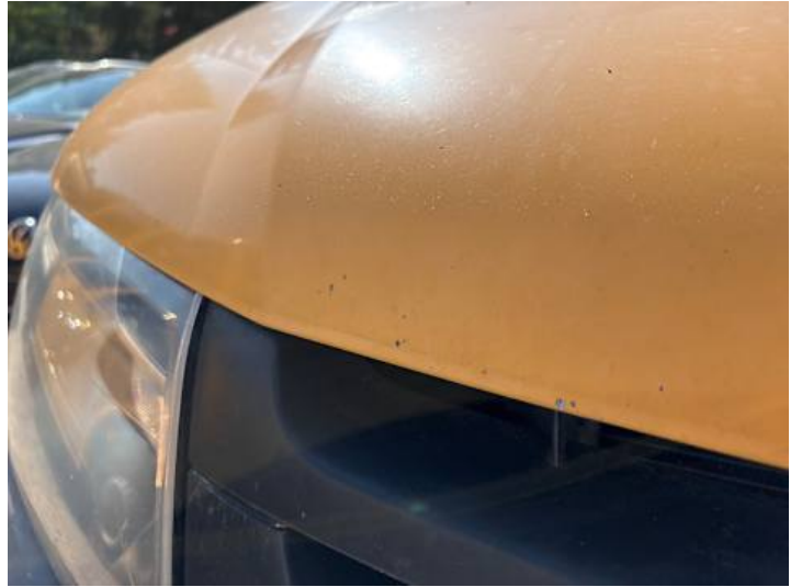
Motorhaube (Rost, Steinschlag)
