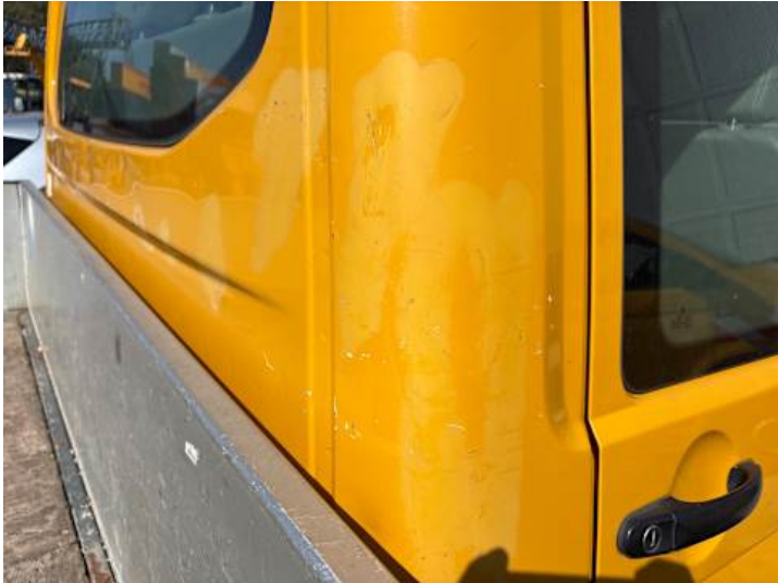
Seitenteil hinten rechts (Lackschaden)
