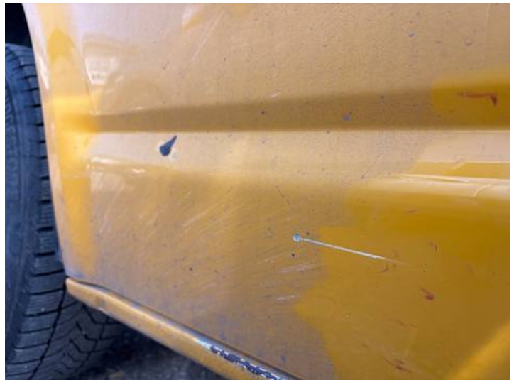
Fahrertür (Lackschaden, Kratzer)
