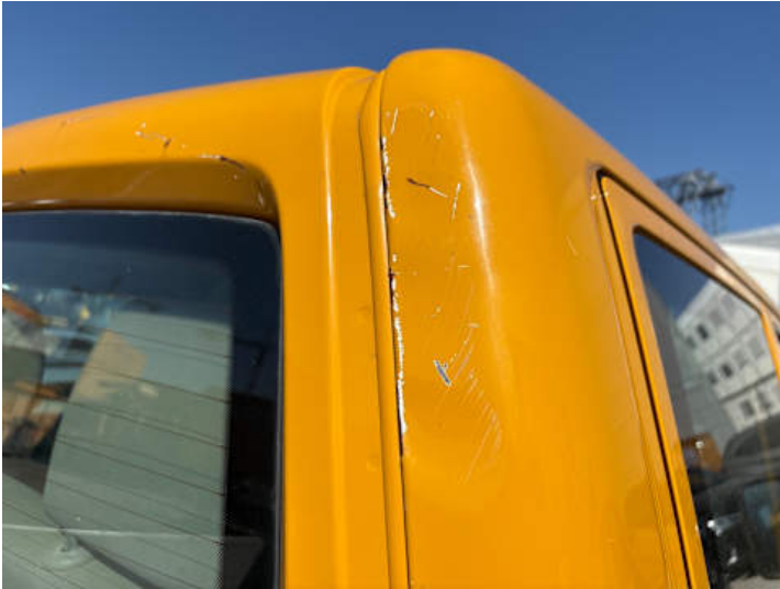
Seitenteil hinten rechts (Lackschaden)
