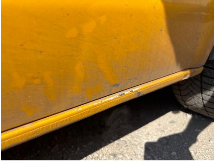
Schweller rechts (Kratzer, Lackschaden)
