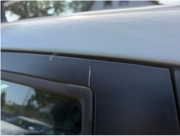
Türe hinten links (Lackschaden)
