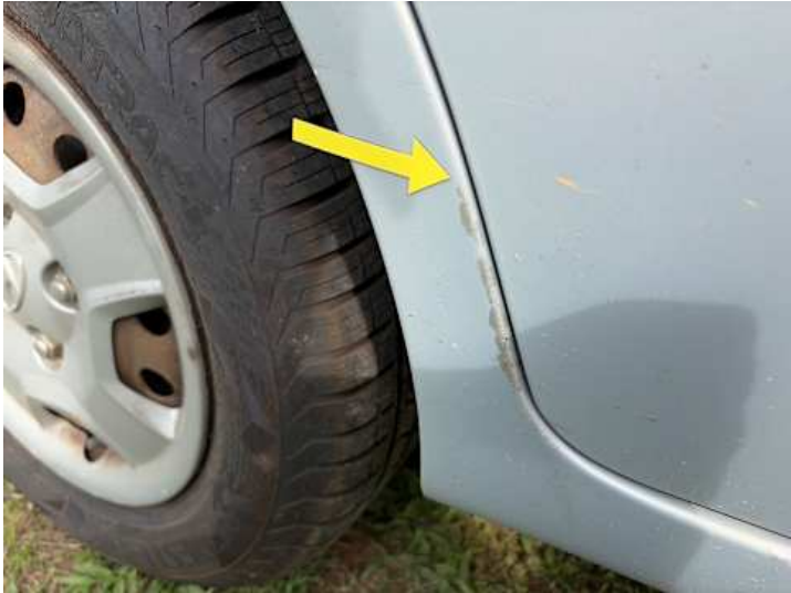
Schweller rechts (Lackschaden)
