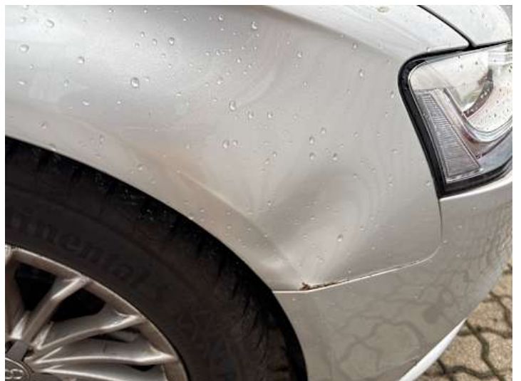
Kotflügel vorne rechts (Rost, Verformung)
