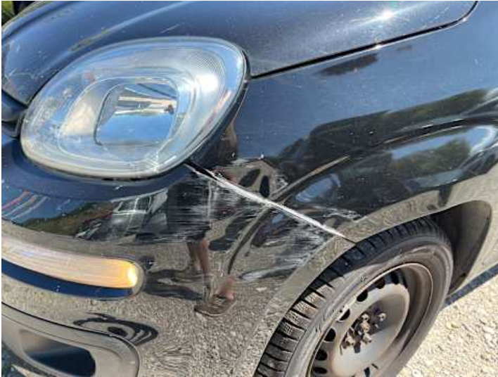
Kotflügel vorne links (Verformung, Lackschaden, Spaltmaße ungenau)
