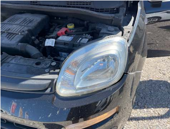
Scheinwerfer (links) (Riss/Bruch)
