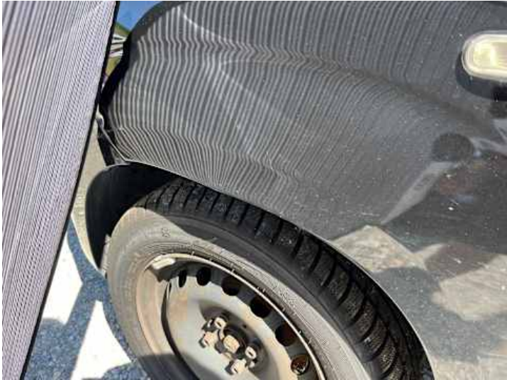
Kotflügel vorne links (Verformung, Lackschaden, Spaltmaße ungenau)
