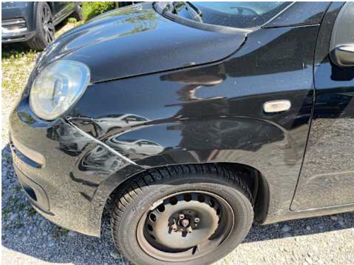
Kotflügel vorne links (Verformung, Lackschaden, Spaltmaße ungenau)
