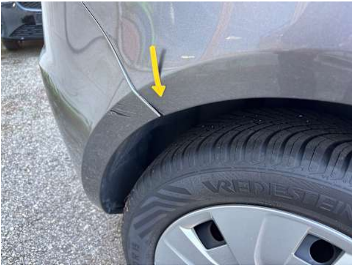
Seitenteil hinten rechts (Verformung)
