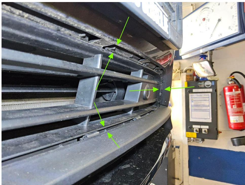
Bild 26 : Anfahrtschaden vorne links, Kühlergrill unten eingedrückt und Diffusor glanzschwarz verschrammt
