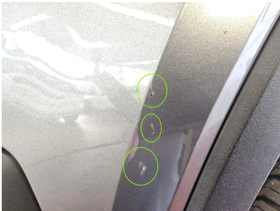
Bild 23 : Stoßfänger vorne leichte Steinschläge und leichte Kratzer, leichte Lackanätzung und links verschrammt
