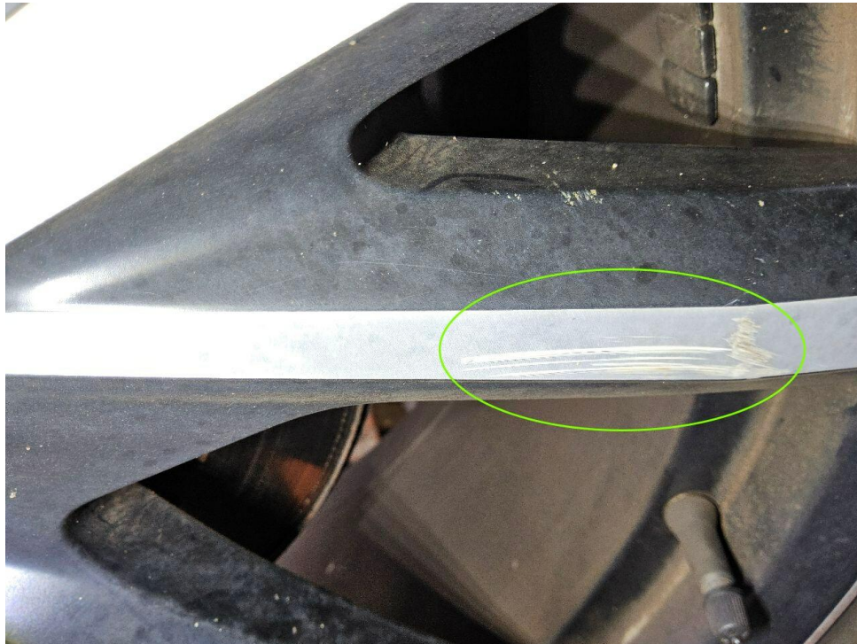
Bild 21 : Streifschaden rechts, Radlauf- u. Türblende verschrammt, Tür hinten verschrammt u. deformiert, Felge glanzgedreht verschrammt
