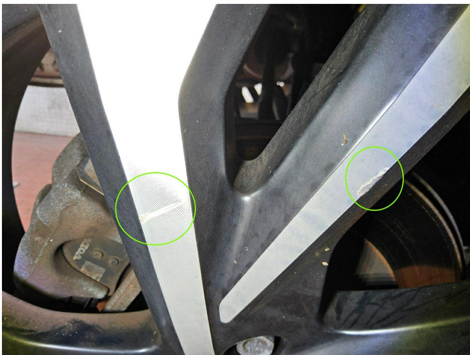
Bild 20 : Streifschaden rechts, Radlauf- u. Türblende verschrammt, Tür hinten verschrammt u. deformiert, Felge glanzgedreht verschrammt
