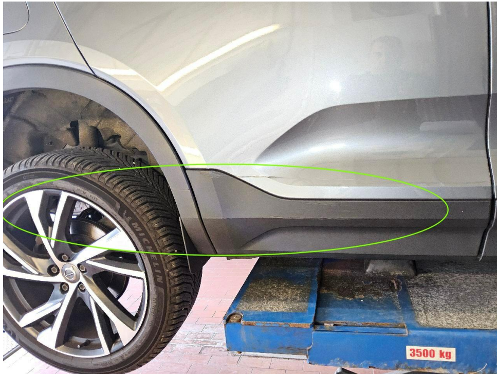
Bild 13 : Streifschaden rechts, Radlauf- u. Türblende verschrammt, Tür hinten verschrammt u. deformiert, Felge glanzgedreht verschrammt
