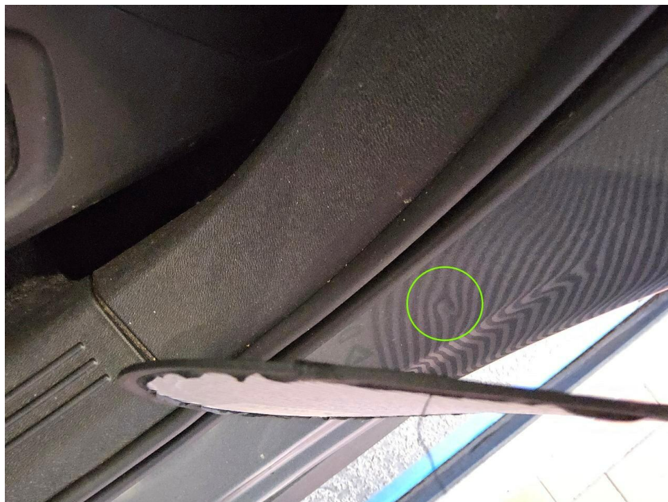
Bild 8 : Türeinstieg vorne links Delle
