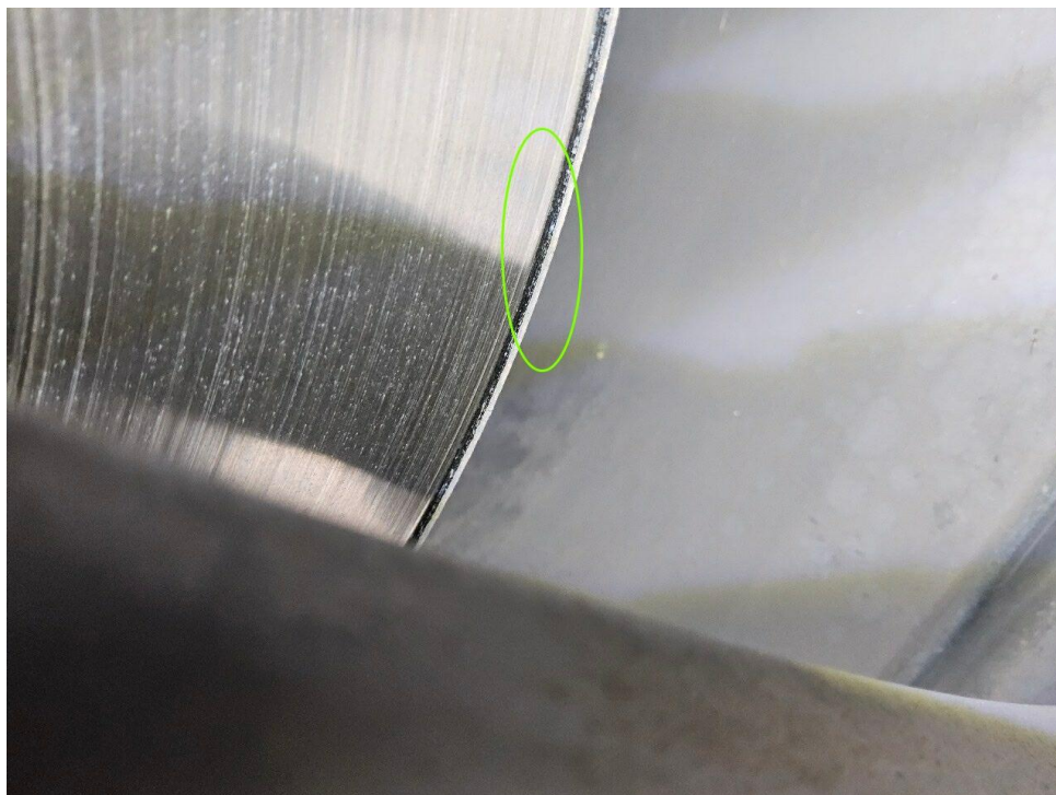
Bild 38 : Bremsscheiben Vorderachse verschlissen
