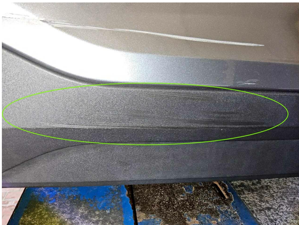
Bild 16 : Streifschaden rechts, Radlauf- u. Türblende verschrammt, Tür hinten verschrammt u. deformiert, Felge glanzgedreht verschrammt
