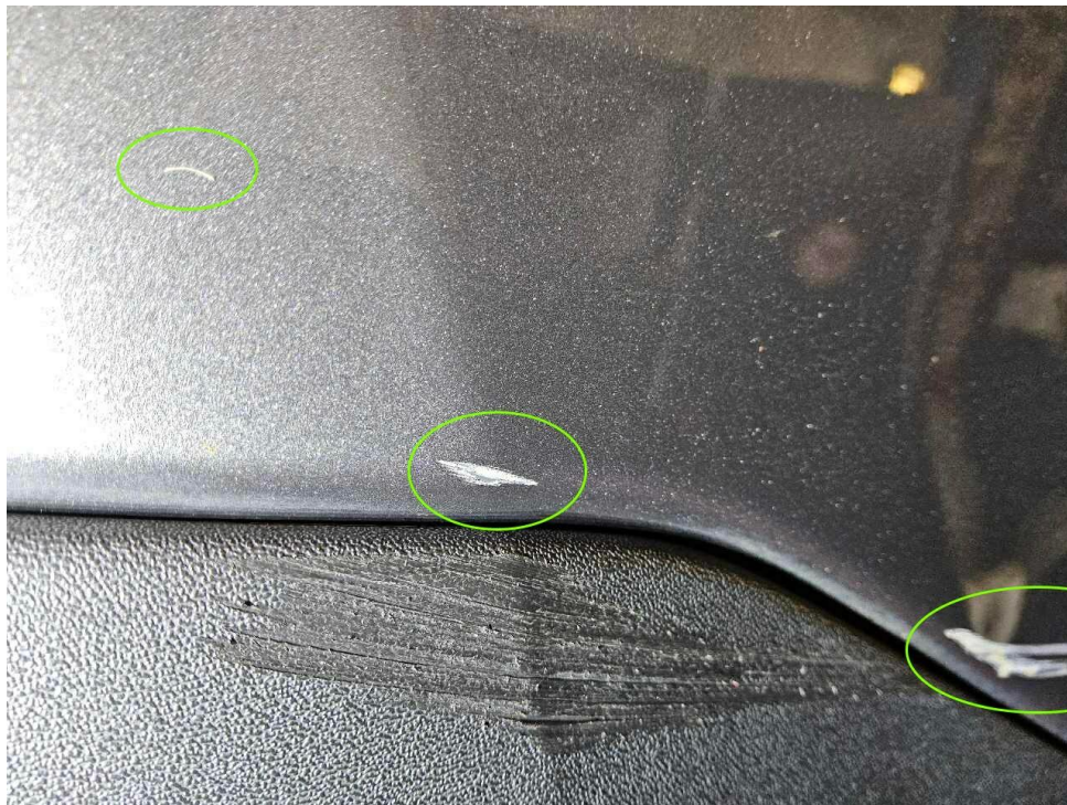
Bild 17 : Streifschaden rechts, Radlauf- u. Türblende verschrammt, Tür hinten verschrammt u. deformiert, Felge glanzgedreht verschrammt
