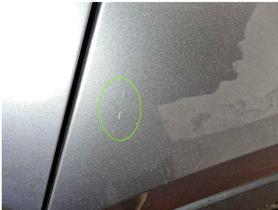
Bild 9 : Seitenwand links Schrammen
