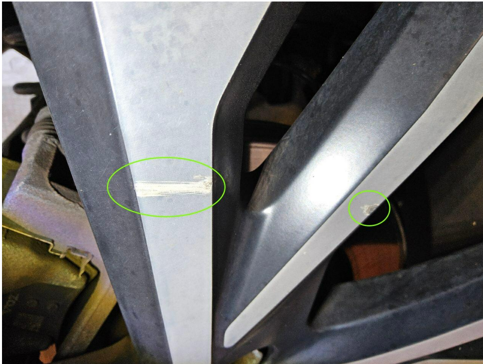
Bild 19 : Streifschaden rechts, Radlauf- u. Türblende verschrammt, Tür hinten verschrammt u. deformiert, Felge glanzgedreht verschrammt
