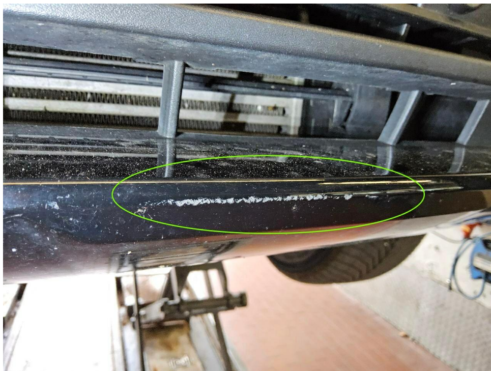
Bild 27 : Anfahrschaden vorne links, Kühlergrill unten eingedrückt und Diffusor glanzschwarz verschrammt
