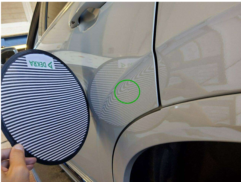
Bild 16 : Tür hinten links, eingedellt und Kante verkratzt
