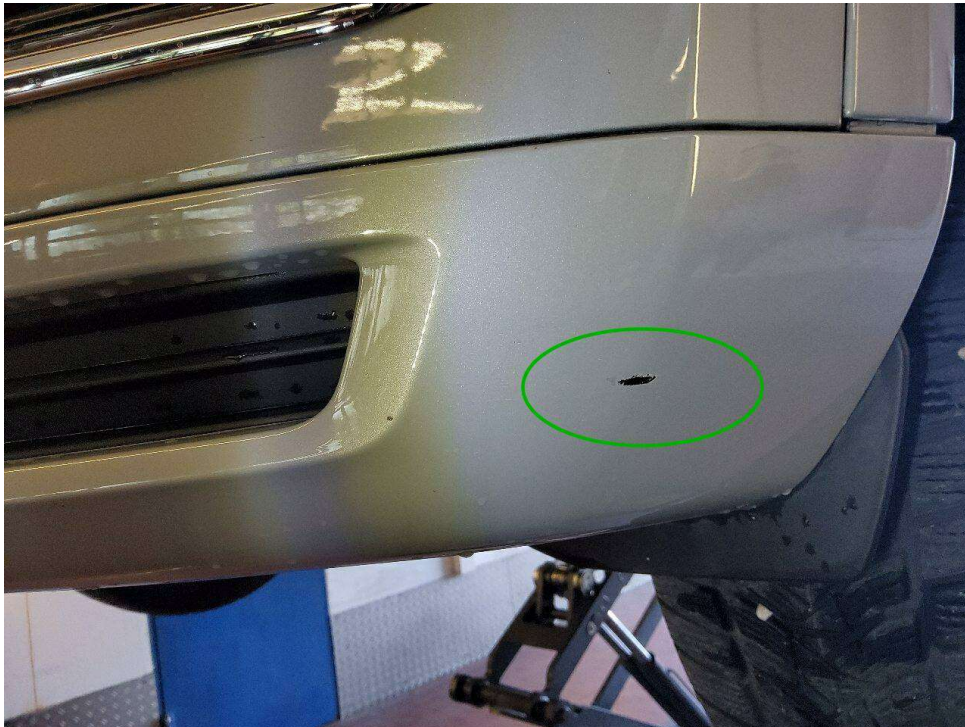
Bild 15 : Stoßfänger vorne, verschrammt
