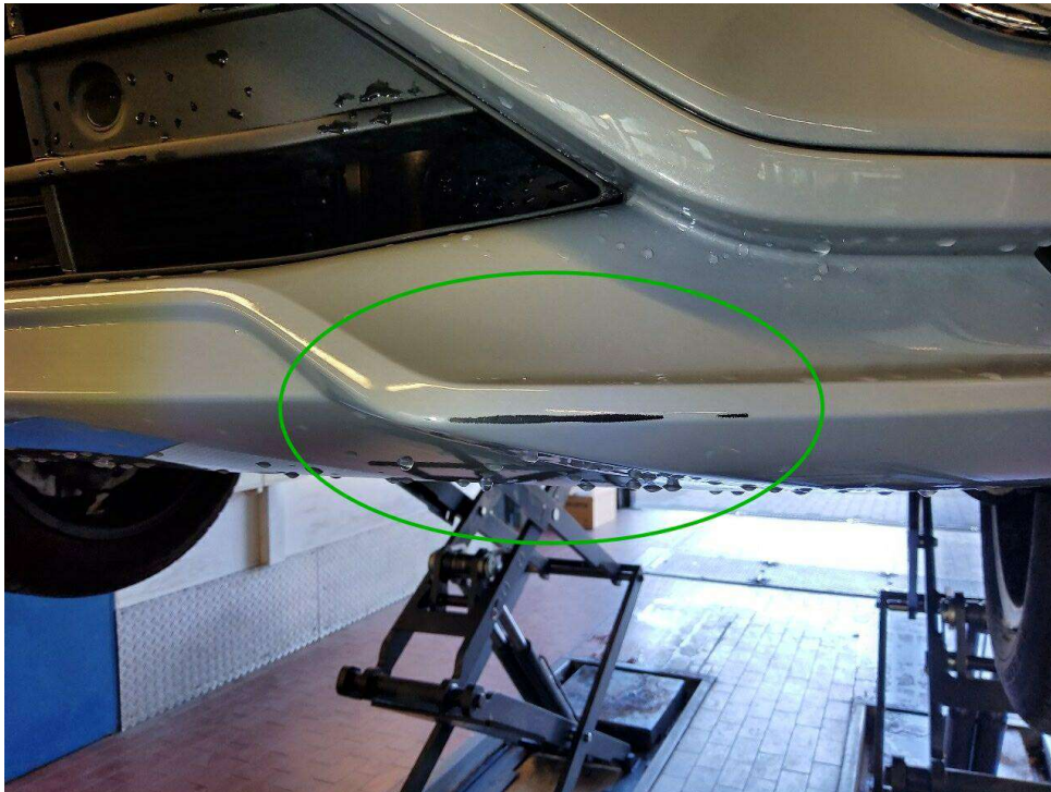
Bild 13 : Stoßfänger vorne, verschrammt
