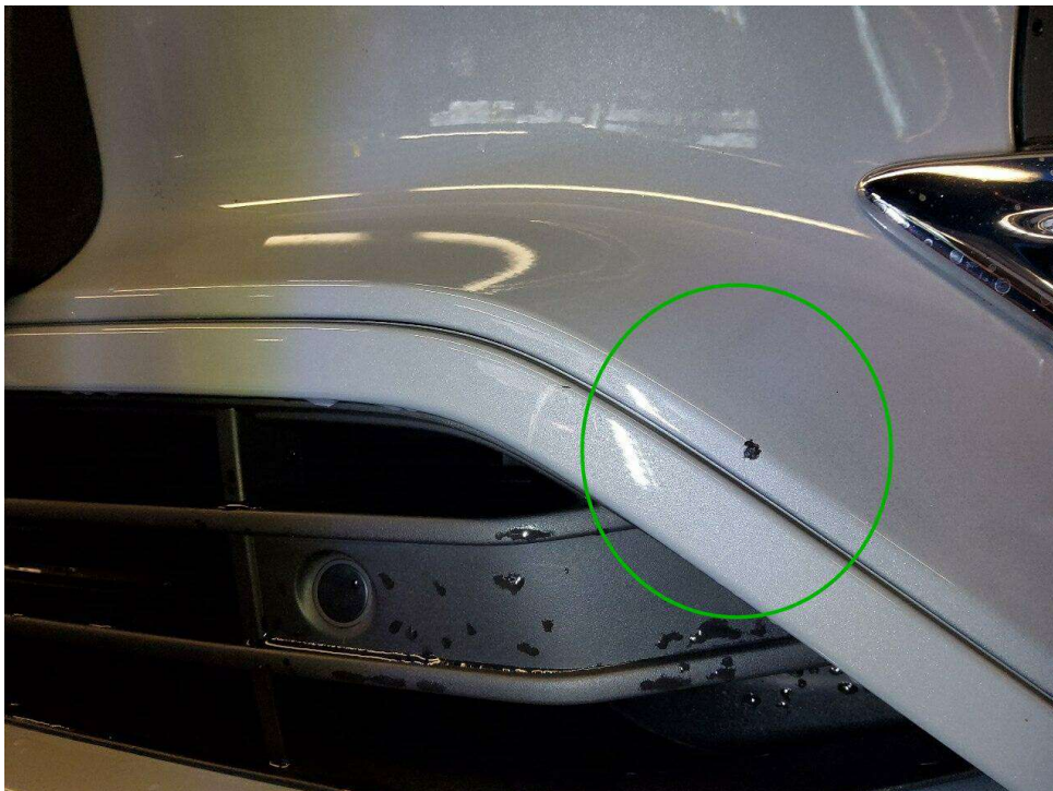
Bild 14 : Stoßfänger vorne, verschrammt
