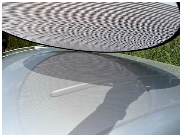
Dach (Verformung, Delle)
