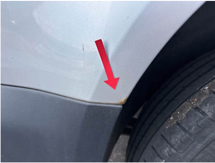
Seitenteil hinten rechts (Rost)
