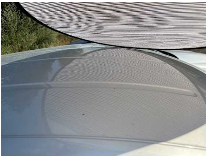
Dach (Verformung, Delle)
