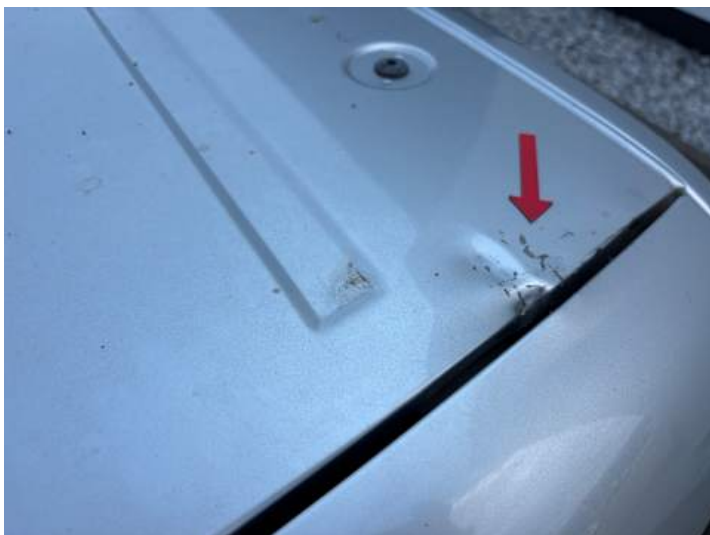
Dach (Verformung, Delle)
