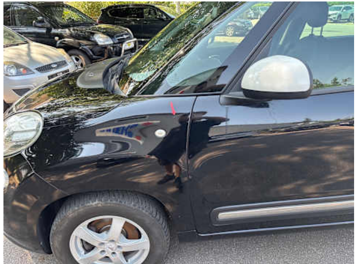
Kotflügel vorne links (Lackschaden, Kratzer)
