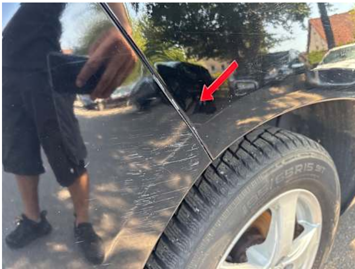
Stoßstange hinten (Lackschaden, Kratzer)
