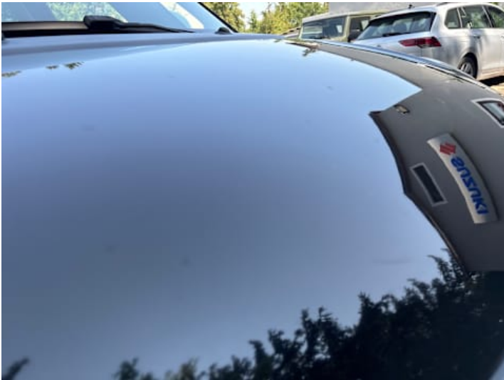
Motorhaube (Anderer Schaden): Mehrere kleine Lackbeschädigungen sichtbar
