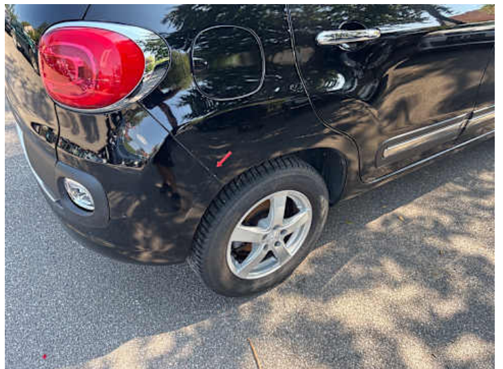
Stoßstange hinten (Lackschaden, Kratzer)
