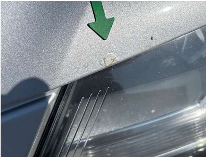
Motorhaube (Rost, Unsachgemäß instand gesetzt)
