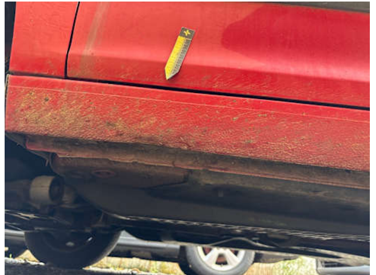
Schweller links (Verformung)
