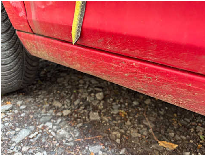
Schweller links (Verformung)
