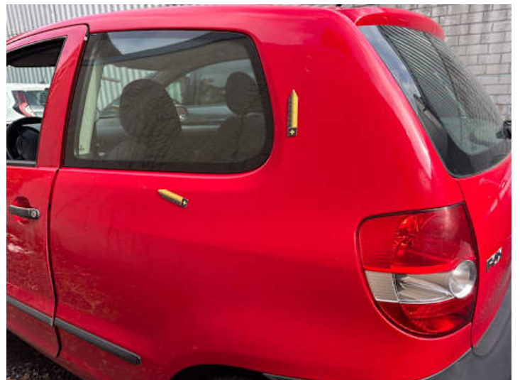
Seitenteil hinten links (Lackschaden)
