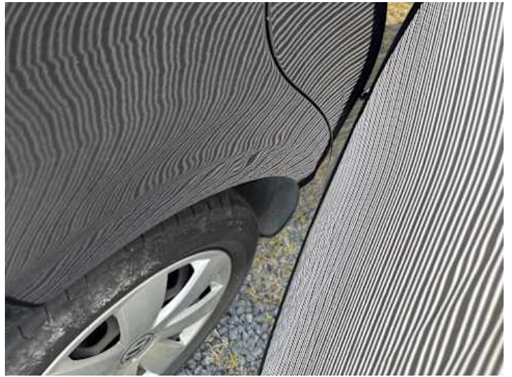
Seitenteil hinten rechts (Delle, Unsachgemäß instand gesetzt, Lackschaden)
