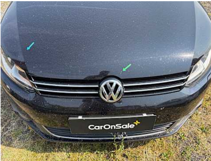
Motorhaube (Delle, Lackschaden, Unsachgemäß instand gesetzt)
