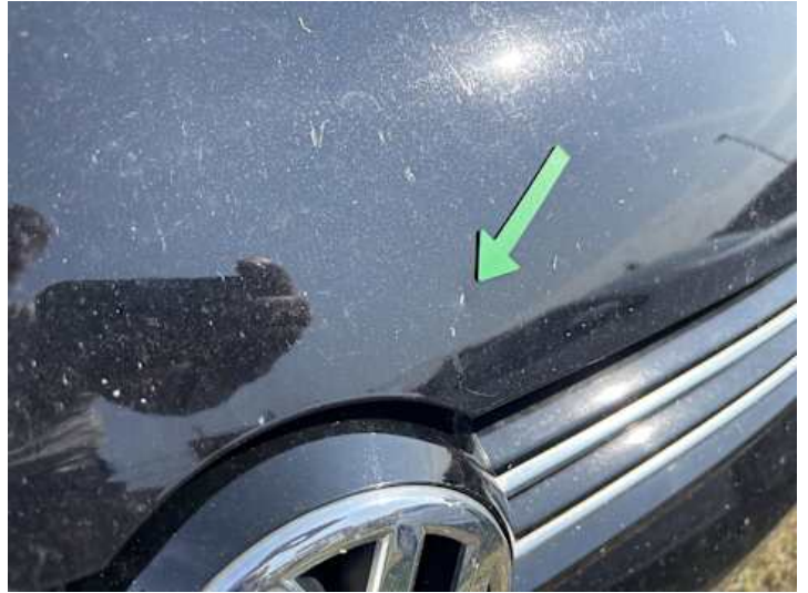
Motorhaube (Delle, Lackschaden, Unsachgemäß instand gesetzt)
