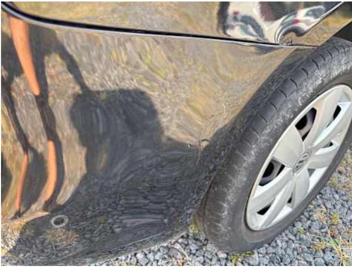
Stoßstange hinten (Kratzer, Lackschaden, Unsachgemäß instand gesetzt)
