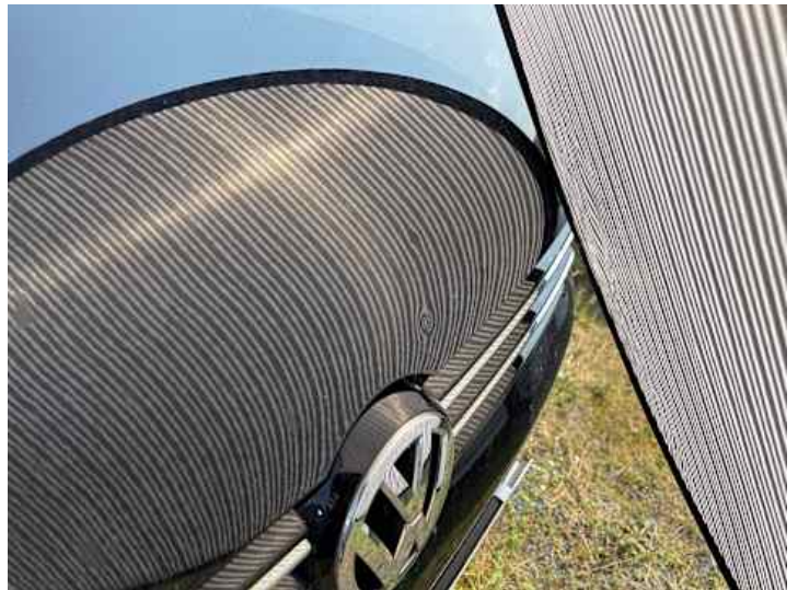
Motorhaube (Delle, Lackschaden, Unsachgemäß instand gesetzt)
