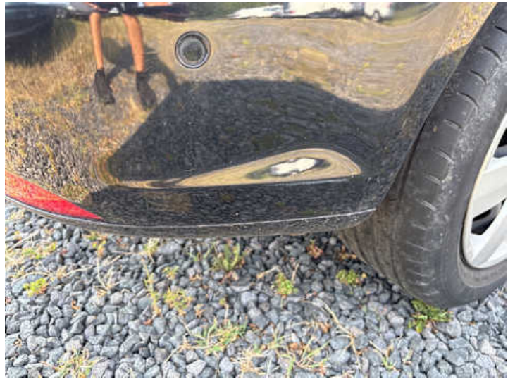
Stoßstange hinten (Kratzer, Lackschaden, Unsachgemäß instand gesetzt)
