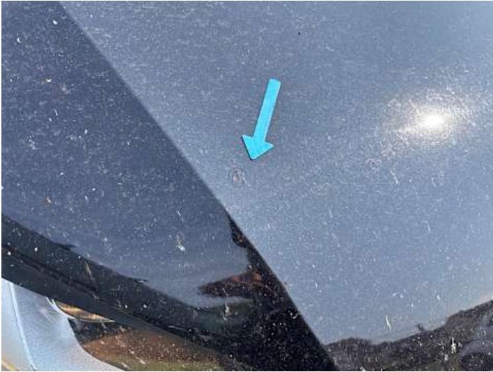
Motorhaube (Delle, Lackschaden, Unsachgemäß instand gesetzt)
