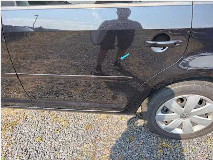
Türe hinten links (Kratzer, Unsachgemäß instand gesetzt)
