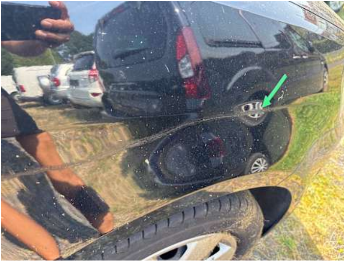
Kotflügel vorne rechts (Lackschaden, Unsachgemäß instand gesetzt)
