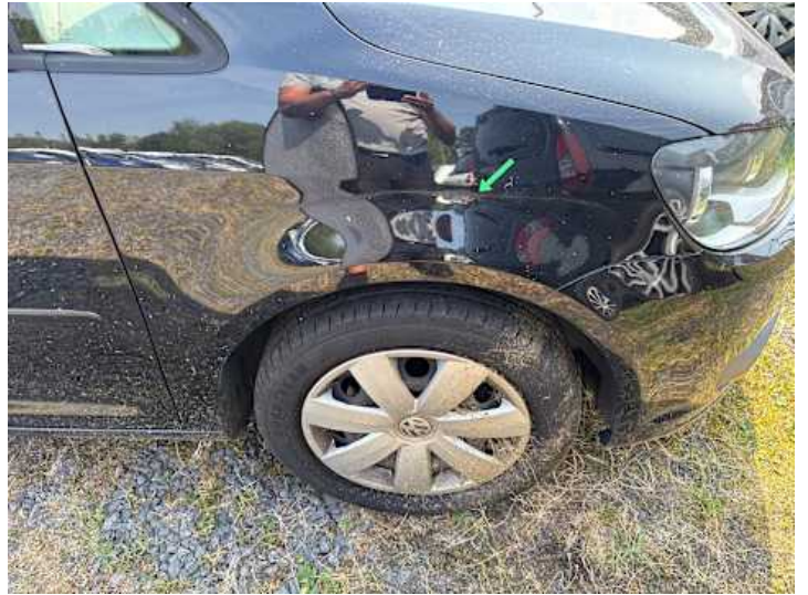
Kotflügel vorne rechts (Lackschaden, Unsachgemäß instand gesetzt)
