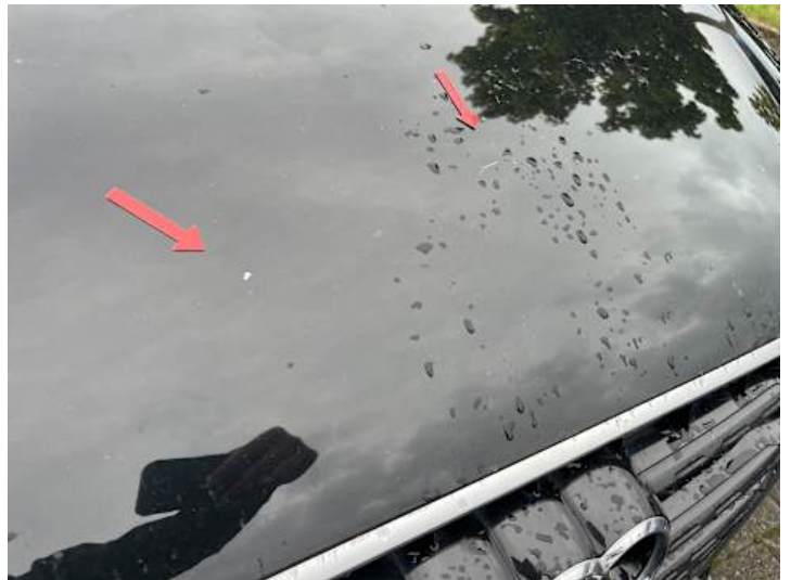
Motorhaube (Steinschlag, Kratzer)
