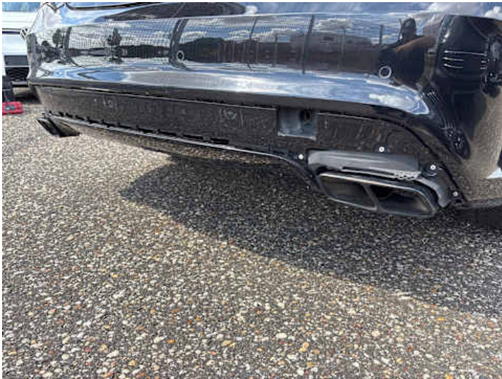
Stoßstange hinten (Riss/Bruch, Anderer Schaden): Fehlteil
