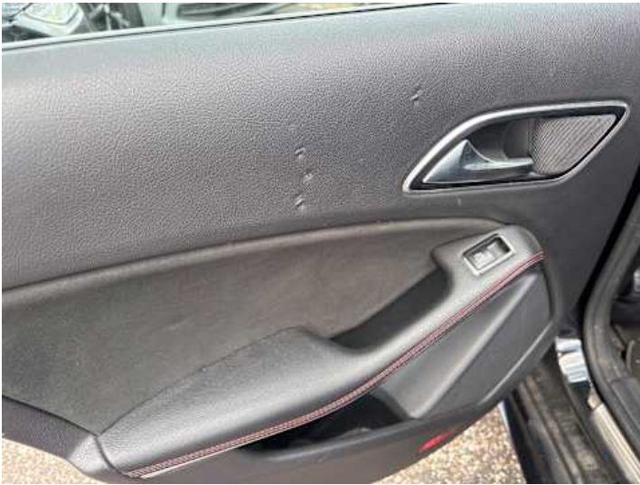
Innenraum (Kratzer, Diverse Schäden)
