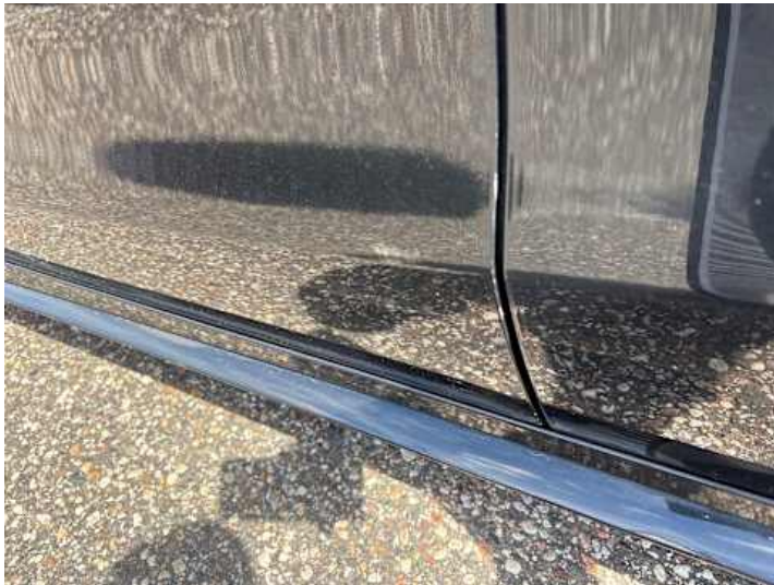
Fahrtür (Delle, Kratzer)
