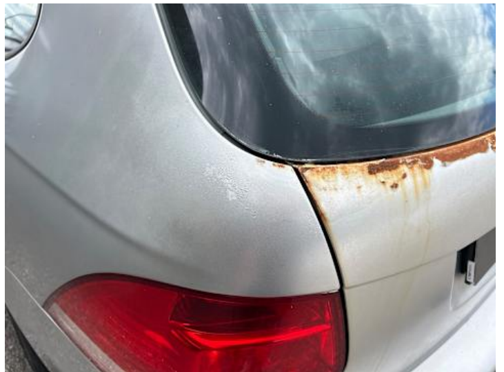
Seitenteil hinten links (Unsachgemäß instand gesetzt, Ausgeblichen/Matt, Rost)
