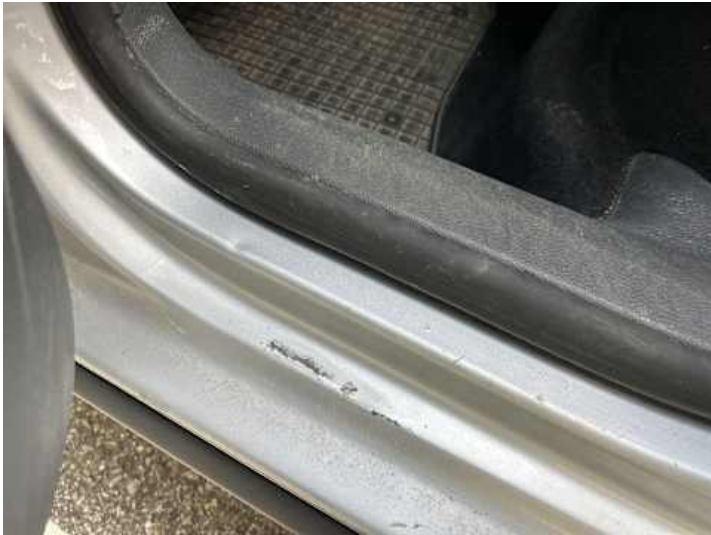
Schweller links (Lackschaden, Delle)
