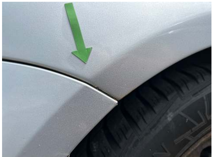
Seitenteil hinten rechts (Rost)
