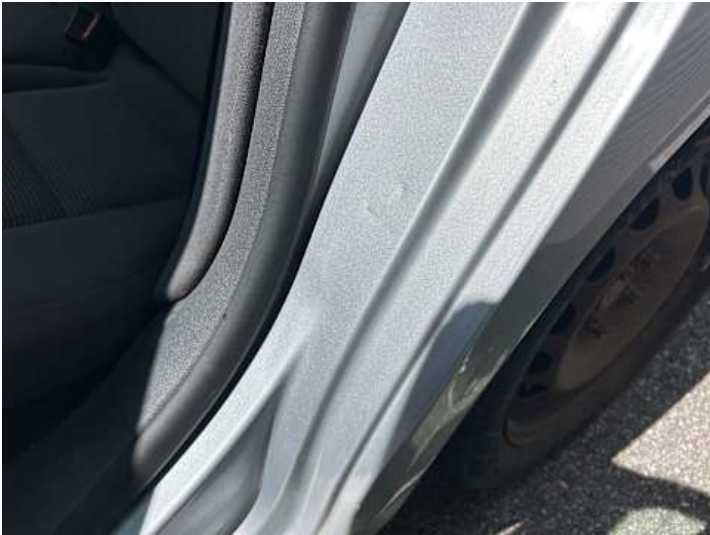
Schweller links (Lackschaden, Delle)
