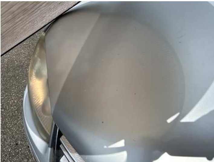
Motorhaube (Unsachgemäß instand gesetzt, Ausgeblichen/Matt)
