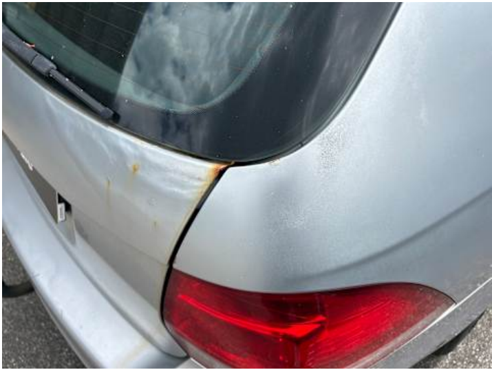
Seitenteil hinten rechts (Unsachgemäß instand gesetzt, Ausgeblichen/Matt, Rost)
