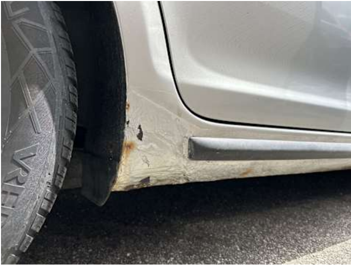
Schweller rechts (Rost)
