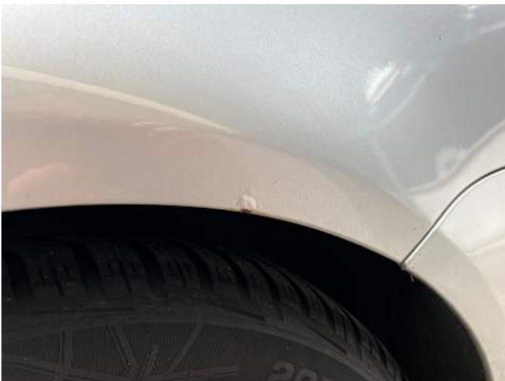
Seitenteil hinten links (Rost)
