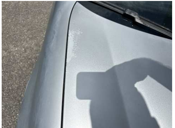
Motorhaube (Unsachgemäß instand gesetzt, Ausgeblichen/Matt)
