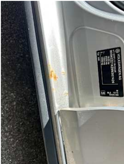
Schweller links (Rost)
