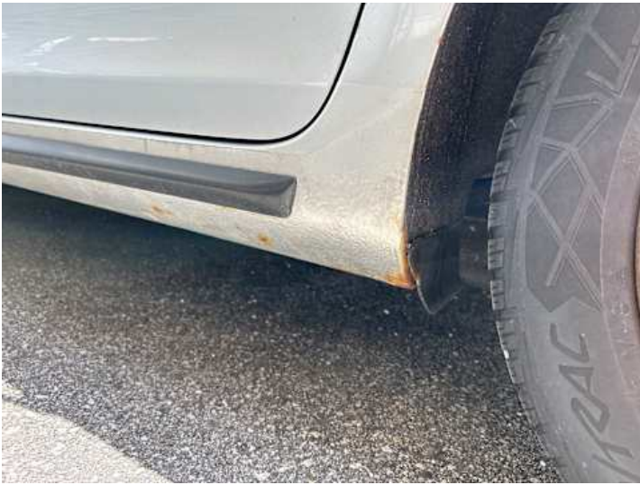
Schweller links (Rost)
