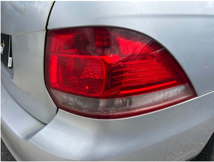
Rücklicht (rechts) (Undicht, Riss/Bruch)
