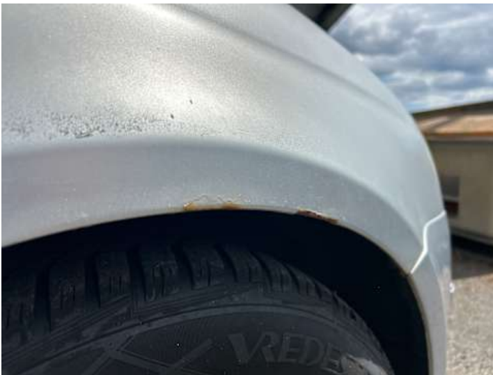
Kotflügel vorne rechts (Rost)
