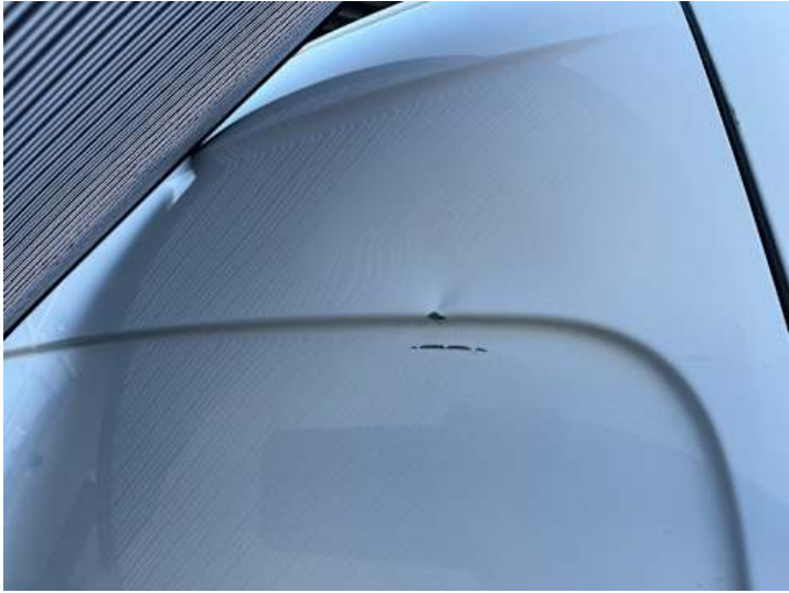
Heckklappe (Delle, Kratzer)
