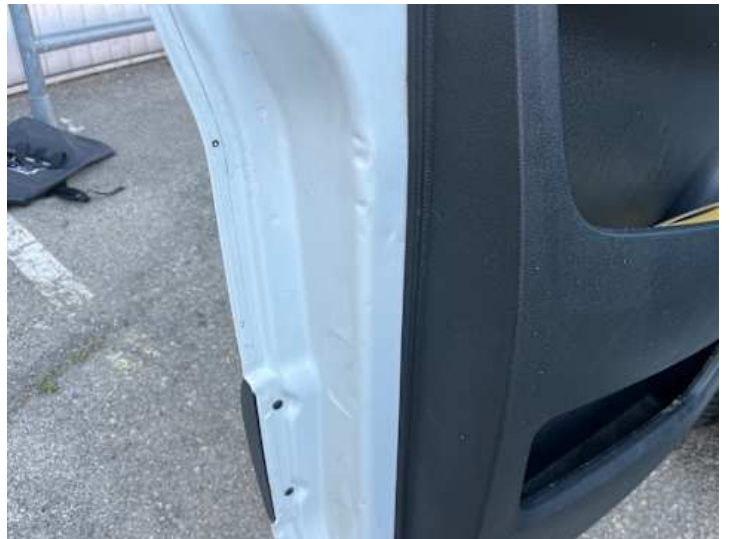
Fahrtür (Delle, Kratzer)
