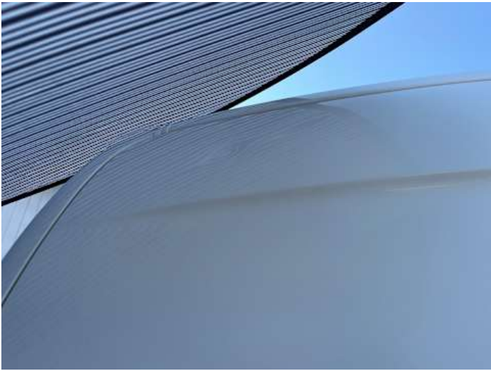
Heckklappe (Delle, Kratzer)
