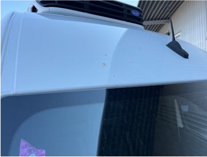
Dach (Steinschlag, Rost)
