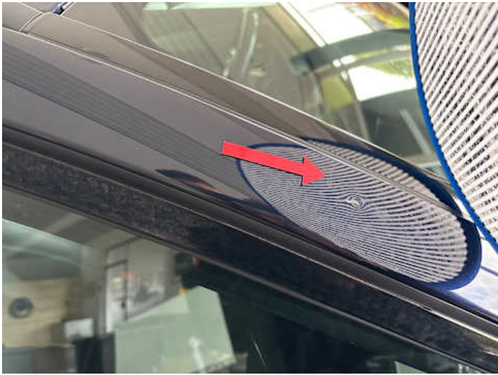
Dach (Kratzer, Delle)
