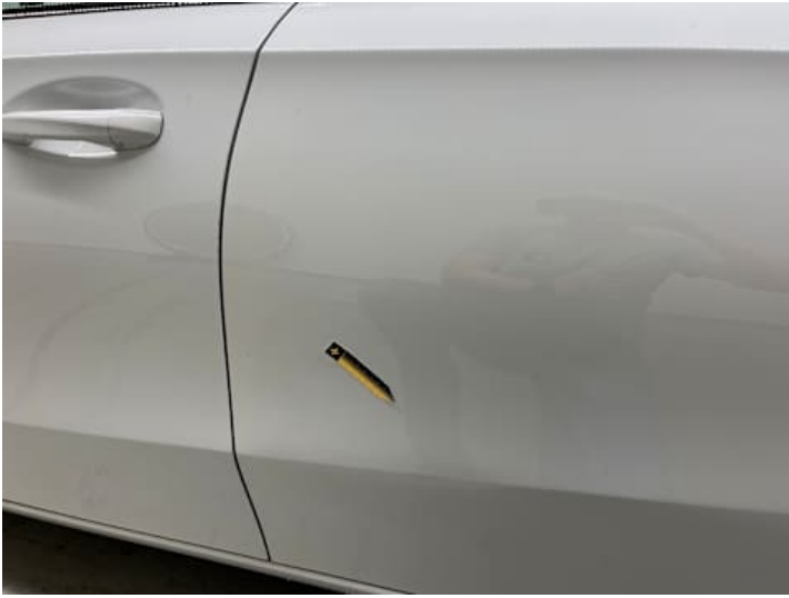
Türe hinten links (Steinschlag)
