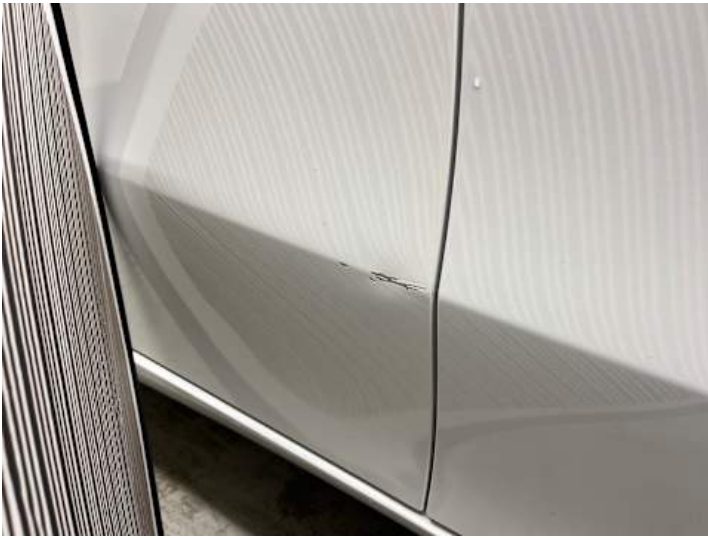
Türe hinten rechts (Delle, Kratzer)
