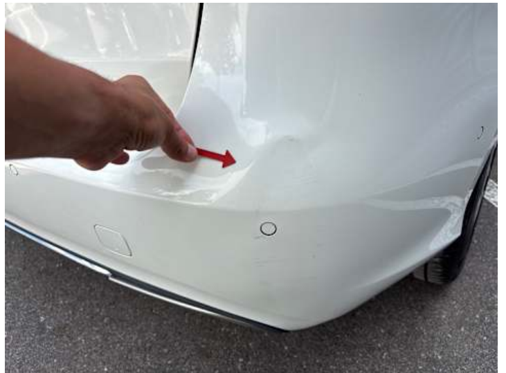
Stoßstange hinten (Verformung)
