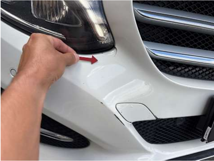
Stoßstange vorne (Riss/Bruch)
