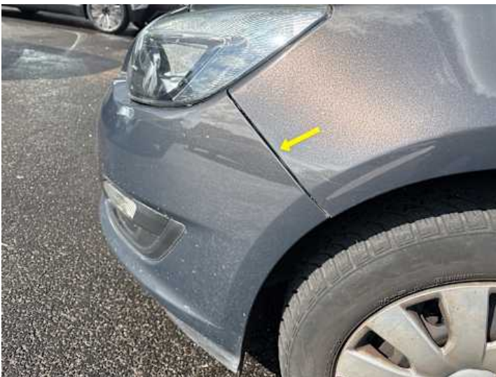
Stoßstange vorne (Spaltmaße ungenau, Unsachgemäß instand gesetzt)
