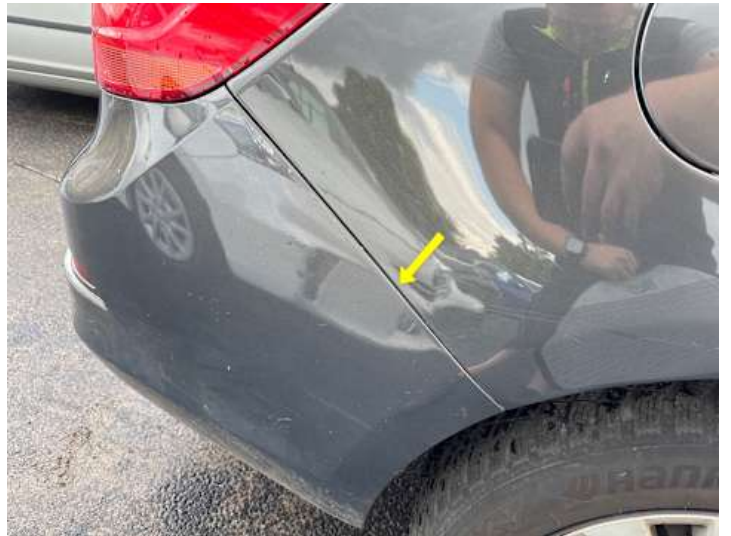
Stoßstange hinten (Unsachgemäß instand gesetzt)
