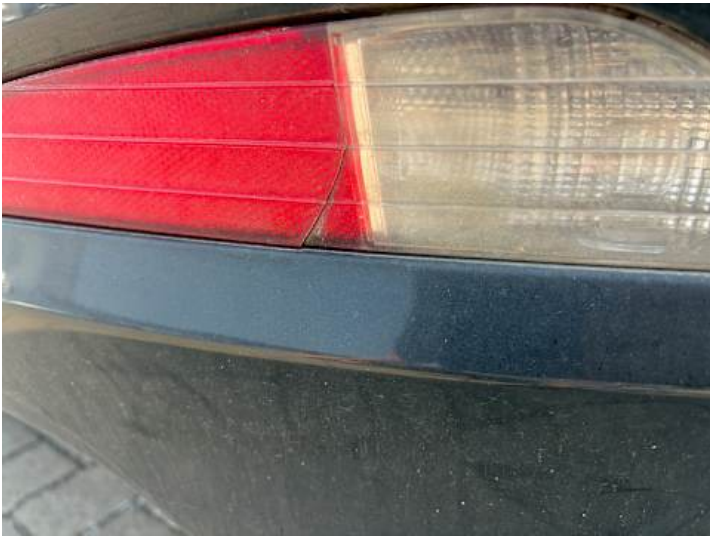
Stoßstange hinten (Lackschaden, Riss/Bruch)
