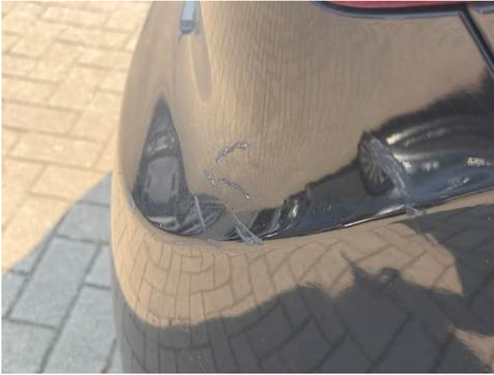
Stoßstange hinten (Lackschaden, Riss/Bruch)
