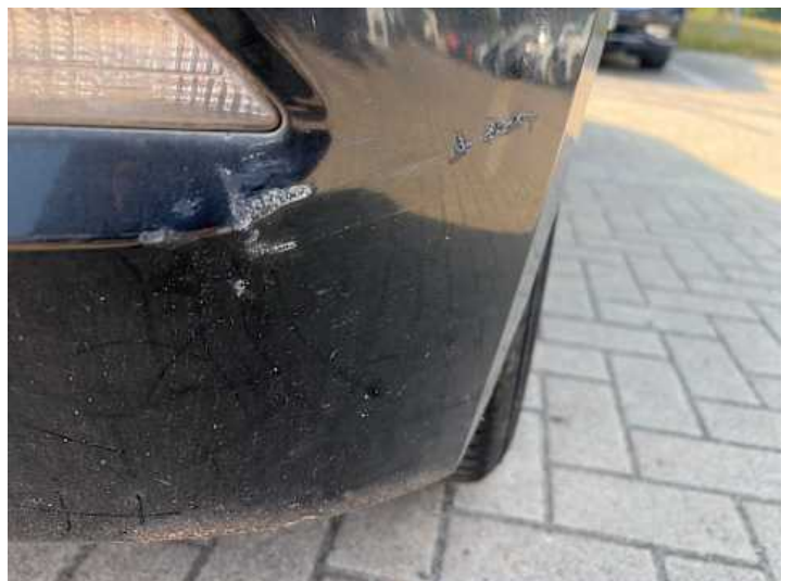
Stoßstange hinten (Lackschaden, Riss/Bruch)
