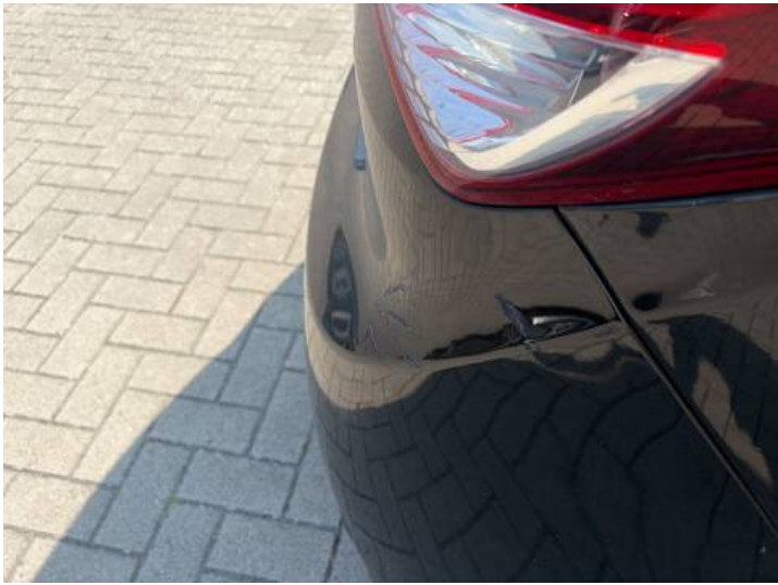
Stoßstange hinten (Lackschaden, Riss/Bruch)
