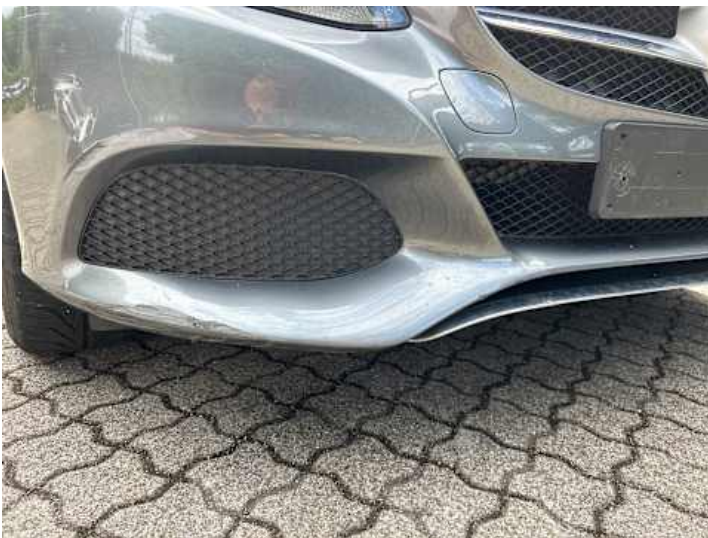
Stoßstange vorne (Kratzer, Riss/Bruch, Lackschaden)
