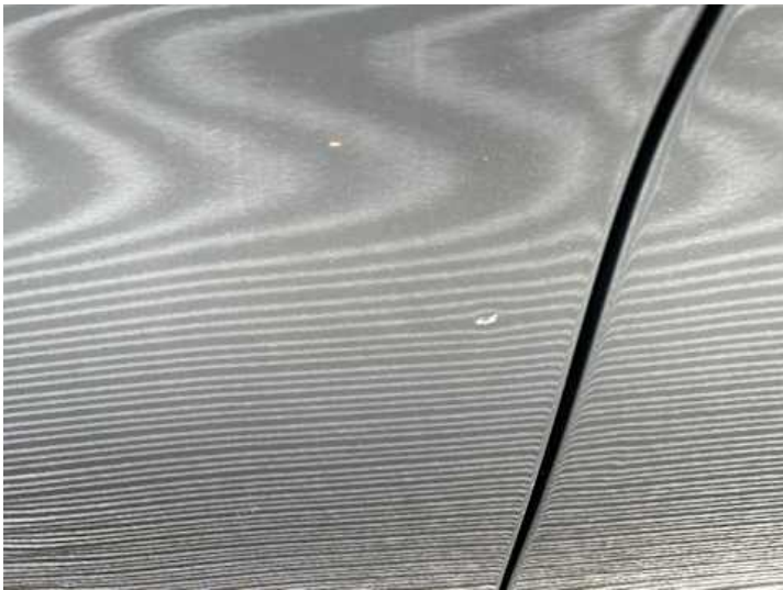
Fahrtür (Delle, Kratzer)
