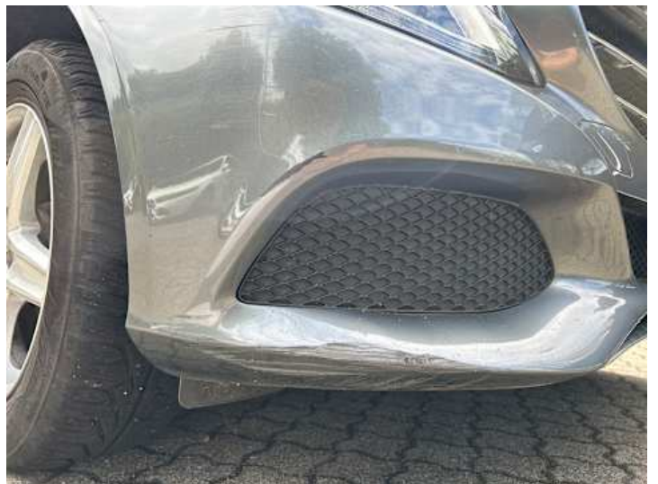
Stoßstange vorne (Kratzer, Riss/Bruch, Lackschaden)
