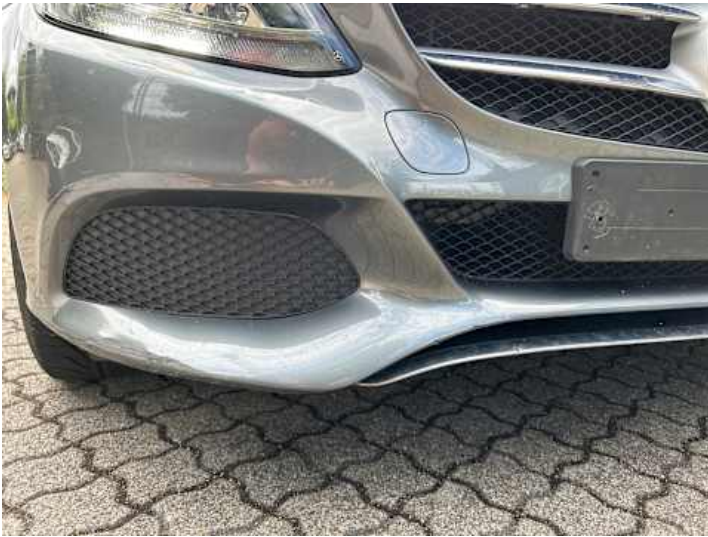
Stoßstange vorne (Kratzer, Riss/Bruch, Lackschaden)
