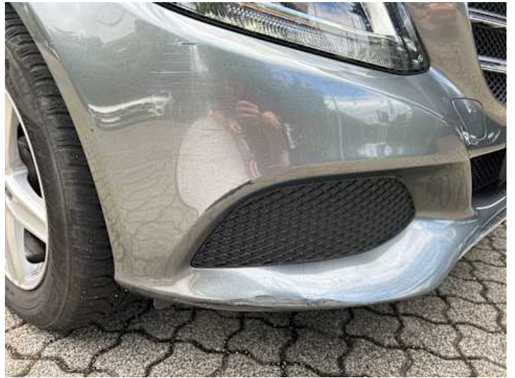
Stoßstange vorne (Kratzer, Riss/Bruch, Lackschaden)
