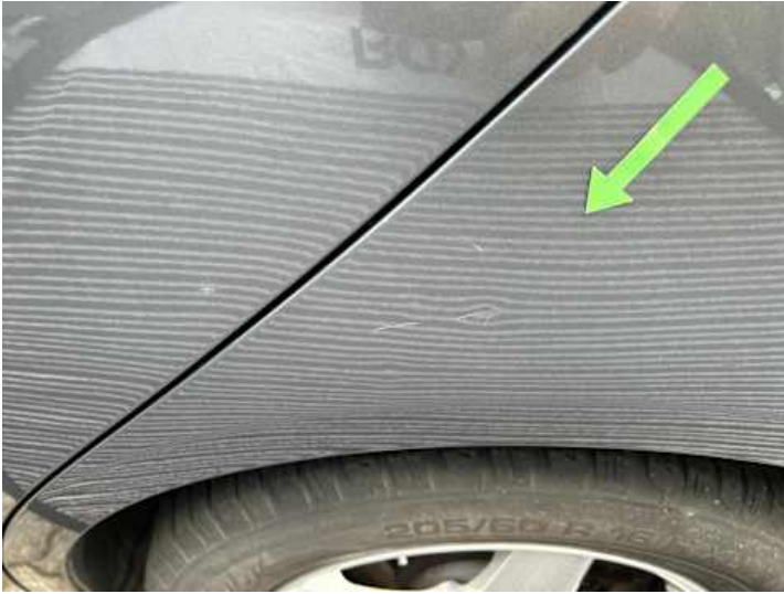
Seitenteil hinten links (Delle, Kratzer)
