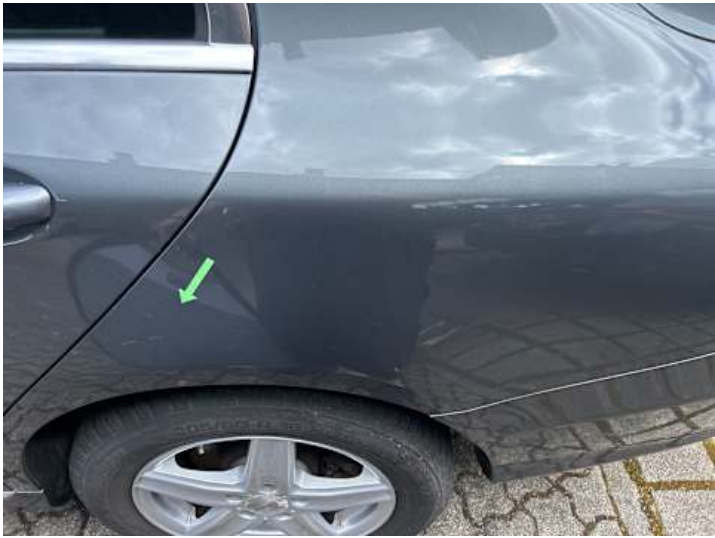
Seitenteil hinten links (Delle, Kratzer)
