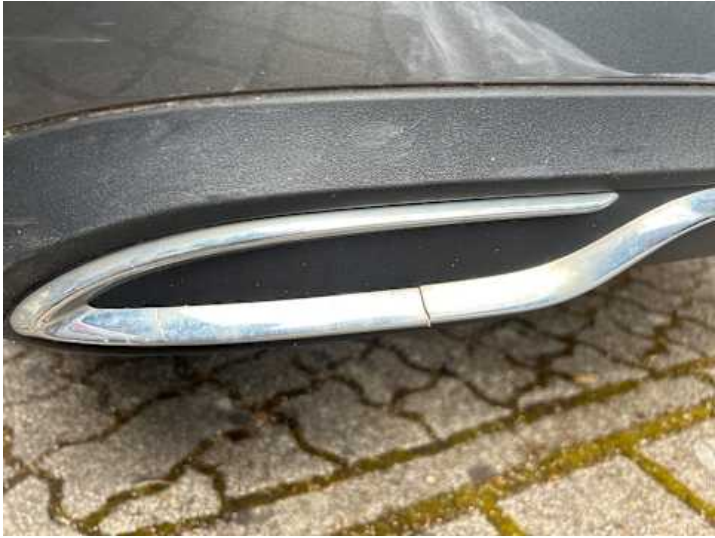
Stoßstange hinten (Riss/Bruch, Kratzer)
