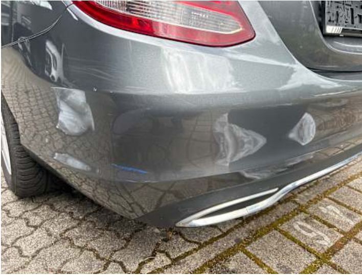
Stoßstange hinten (Riss/Bruch, Kratzer)
