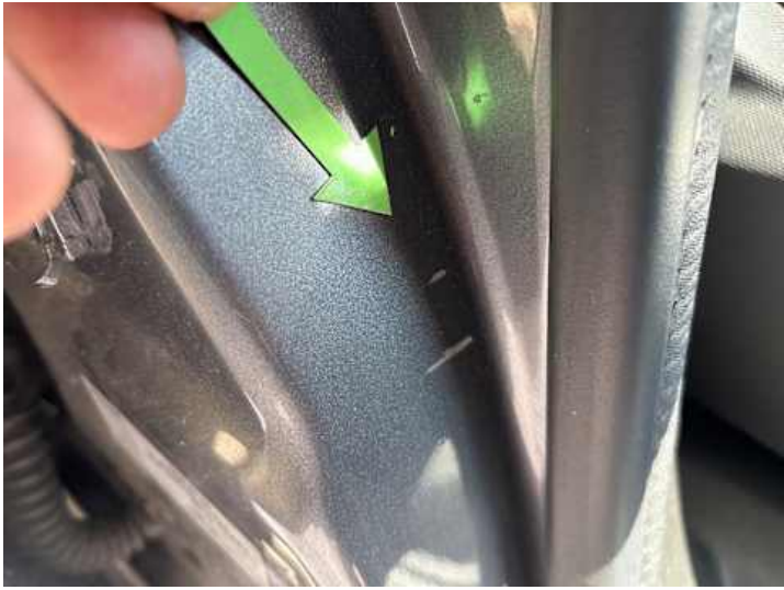
Schweller rechts (Kratzer)
