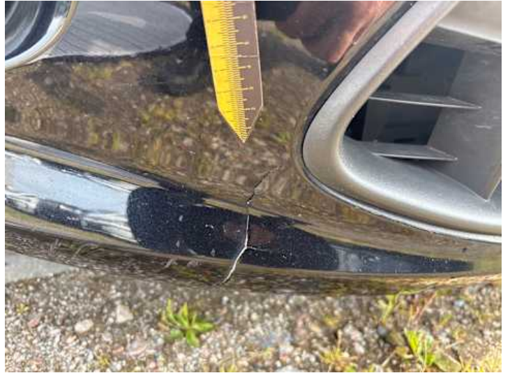
Stoßstange vorne (Riss/Bruch)
