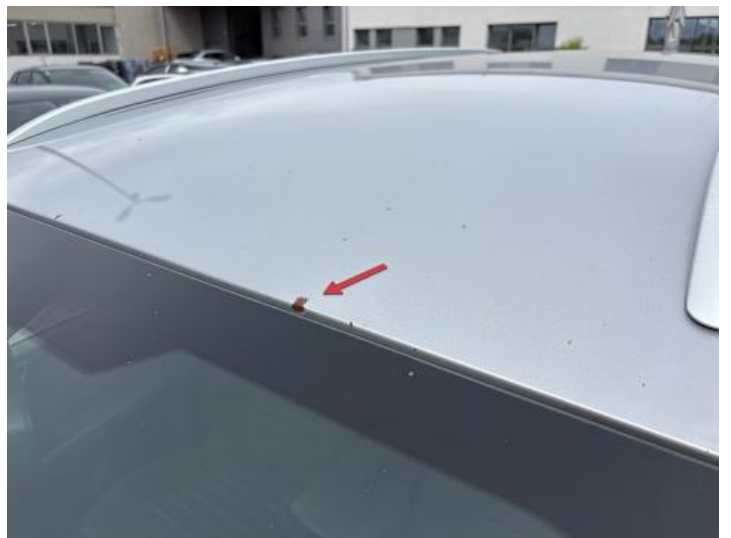
Dach (Steinschlag, Rost)
