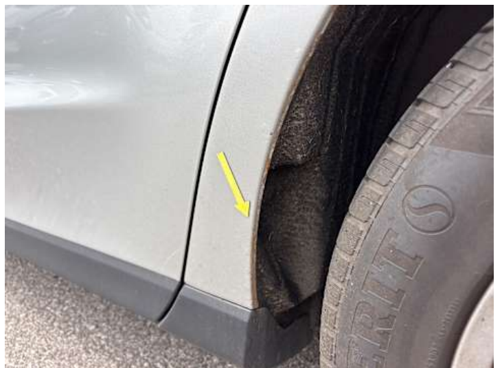
Seitenteil hinten links (Steinschlag, Rost)
