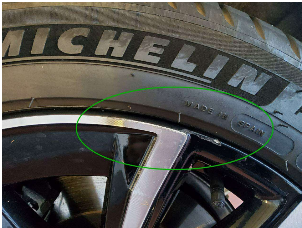
Bild 9 : Felge hinten links, glanzgedreht, verschrammt
