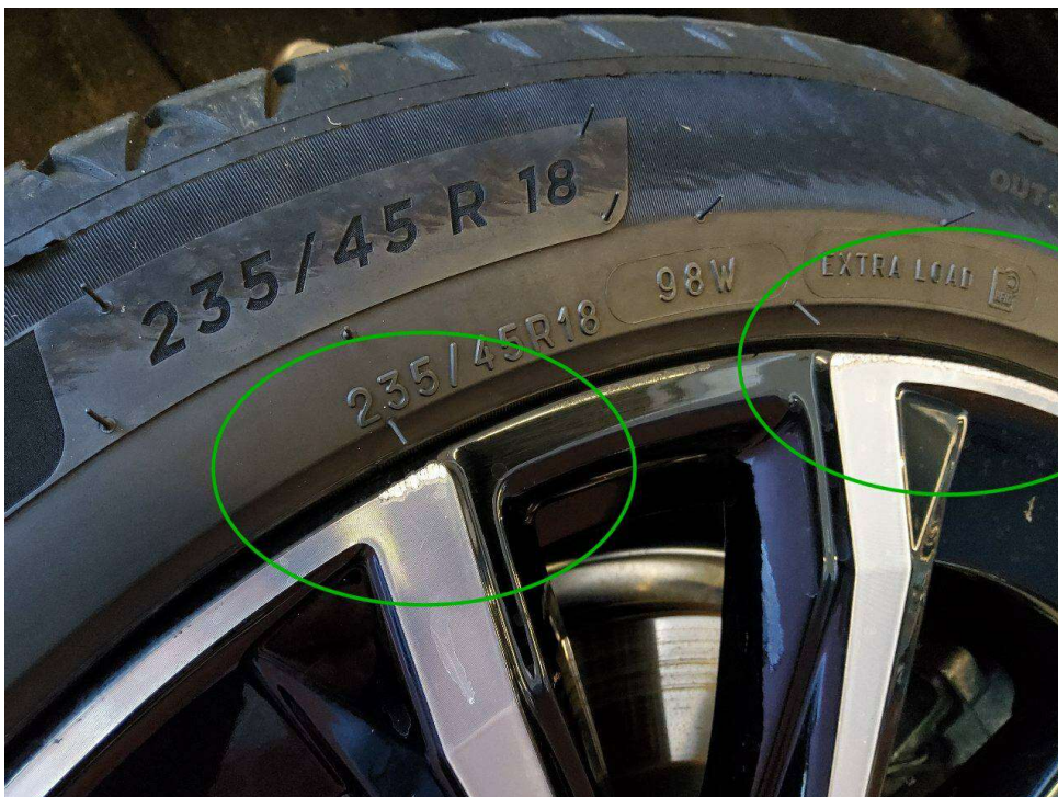
Bild 14 : Felge hinten rechts, glanzgedreht, verschrammt
