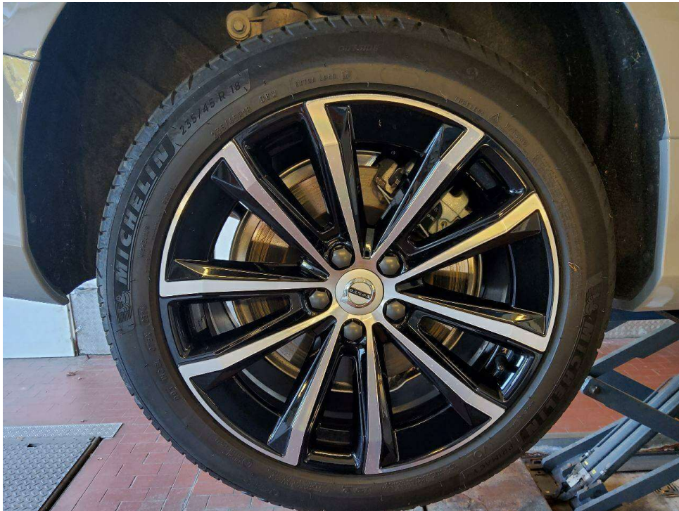
Bild 13 : Felge hinten rechts, glanzgedreht, verschrammt
