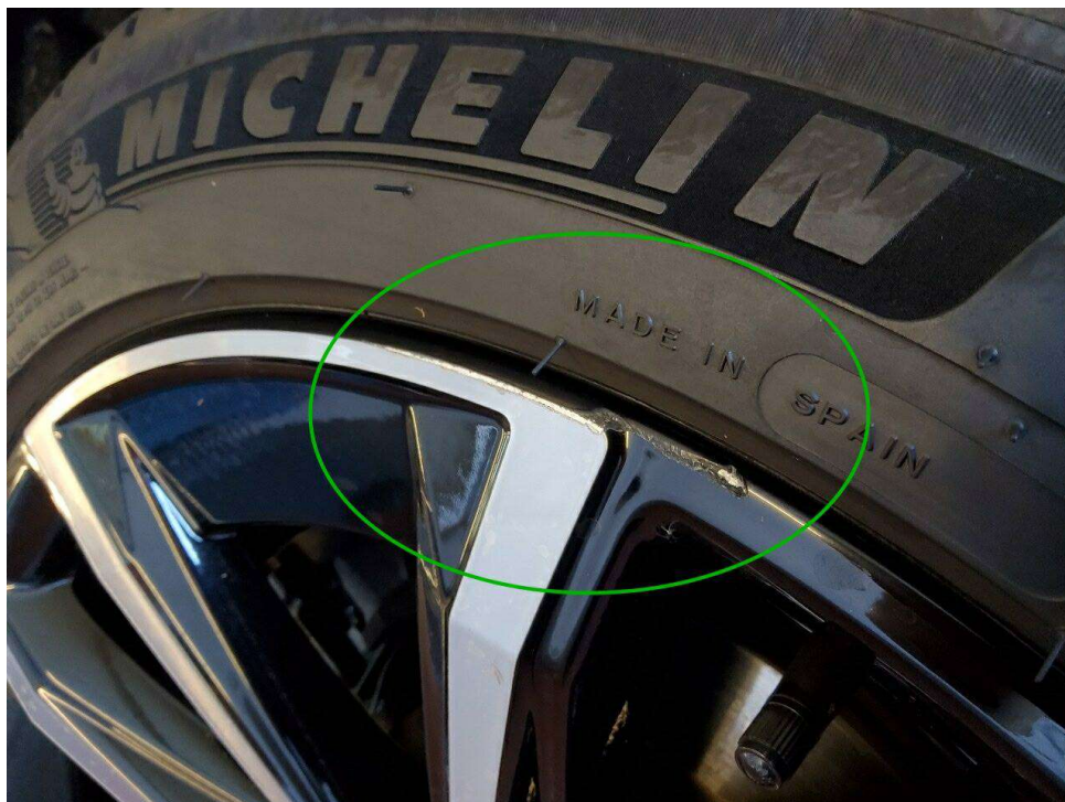
Bild 10 : Felge hinten links, glanzgedreht, verschrammt
