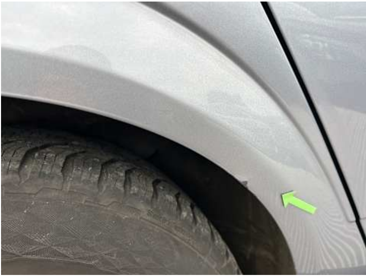
Seitenteil hinten rechts (Rost)
