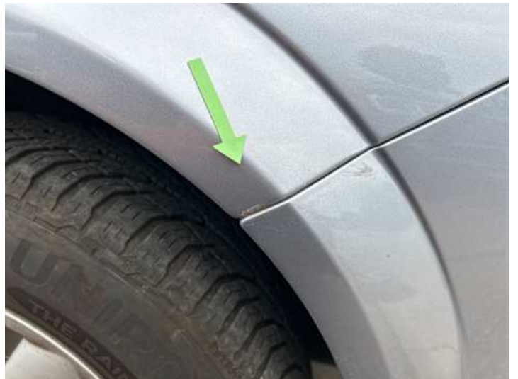
Kotflügel vorne rechts (Rost)
