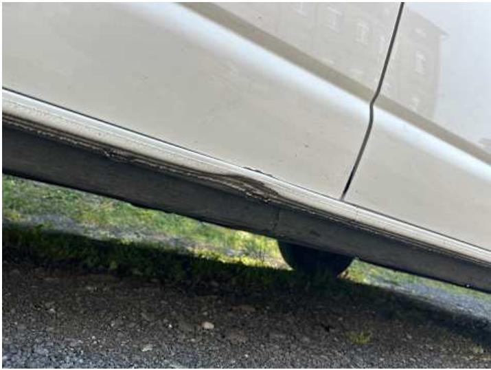
Schweller rechts (Verformung, Lackschaden)
