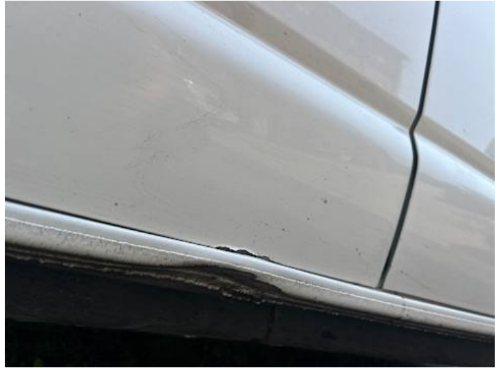
Türe hinten rechts (Rost, Lackschaden)
