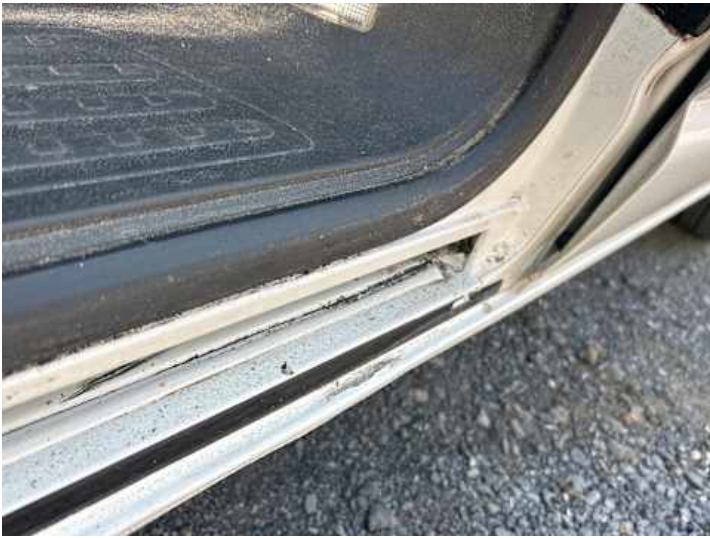
Schweller rechts (Verformung, Lackschaden)
