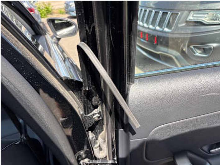
Türe hinten rechts (Riss/Bruch)
