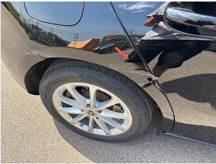
Seitenteil hinten rechts (Kratzer, Verformung)
