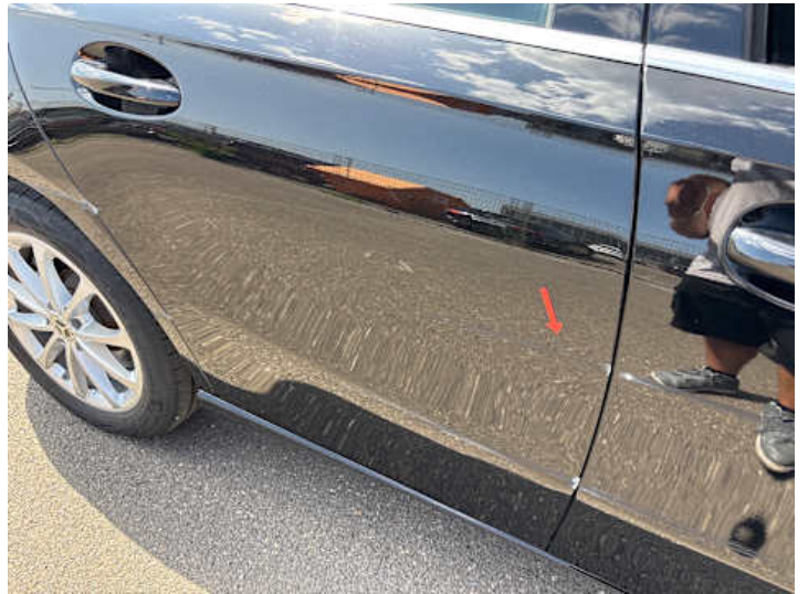
Türe hinten rechts (Kratzer, Verformung)
