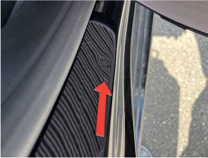
Schweller rechts (Delle)
