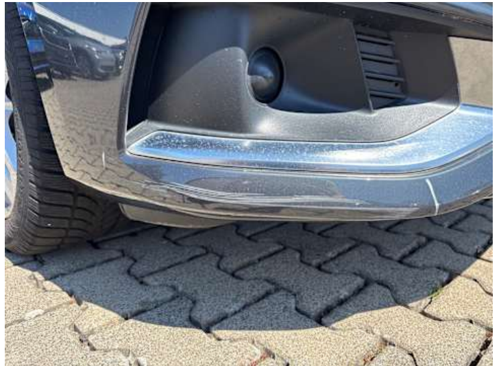
Stoßstange vorne (Lackschaden, Riss/Bruch)
