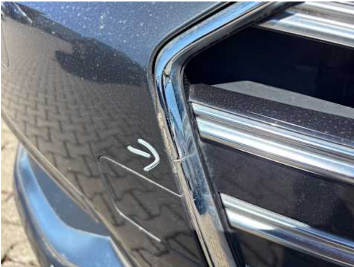
Stoßstange vorne (Lackschaden, Riss/Bruch)
