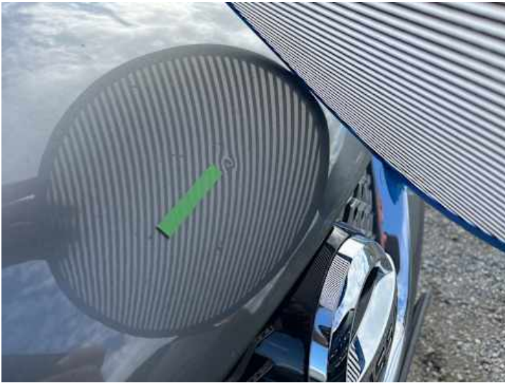
Motorhaube (Steinschlag, Delle)
