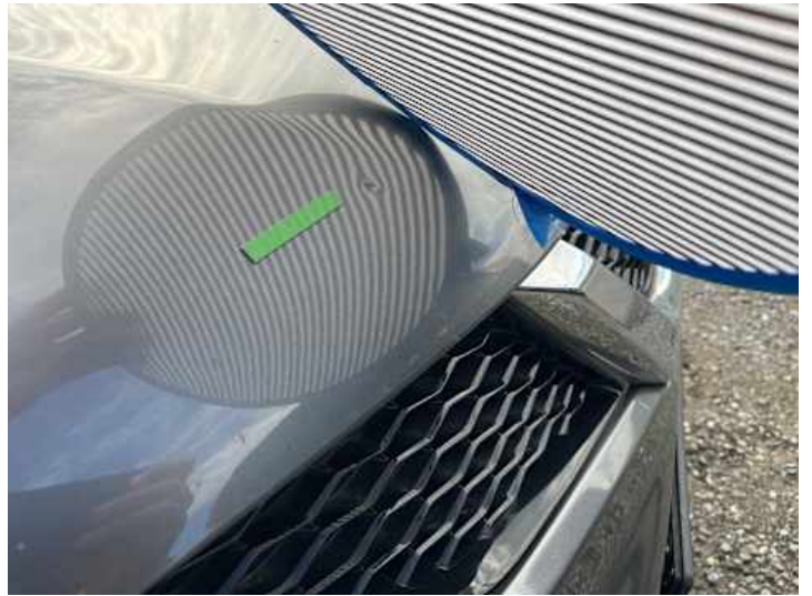
Motorhaube (Steinschlag, Delle)
