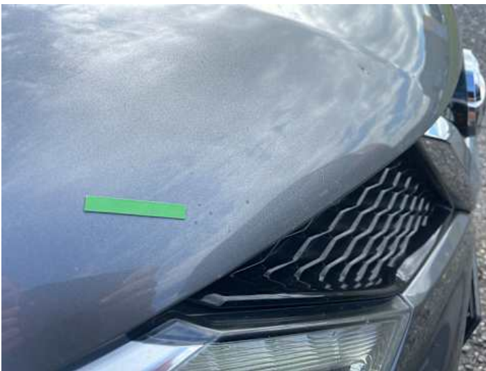
Motorhaube (Steinschlag, Delle)
