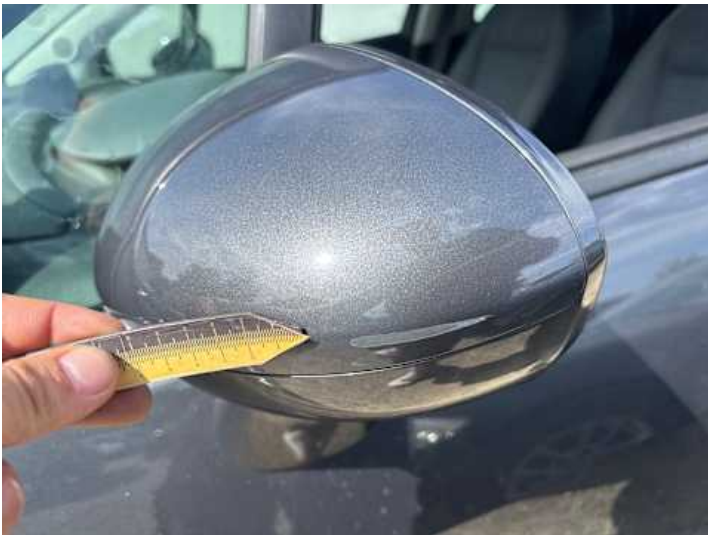
Fahrtür (Lackschaden, Kratzer)
