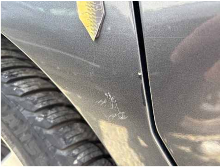
Seitenteil hinten rechts (Lackschaden, Kratzer, Unsachgemäß instand gesetzt)
