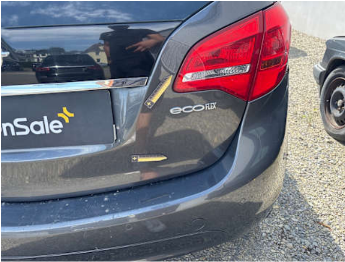
Heckklappe (Lackschaden, Kratzer)
