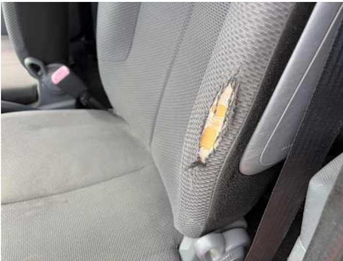
Innenraum (Riss/Bruch, Verschmutzung)
