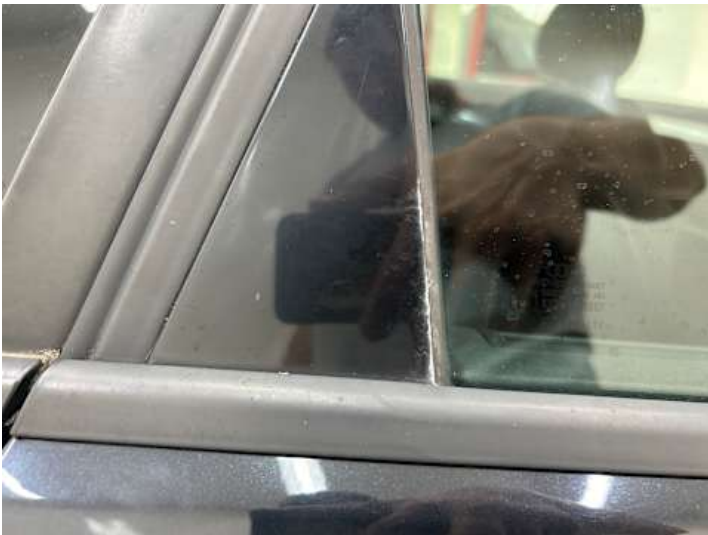
Türe hinten rechts (Rost)
