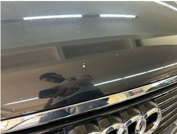
Motorhaube (Rost, Steinschlag)
