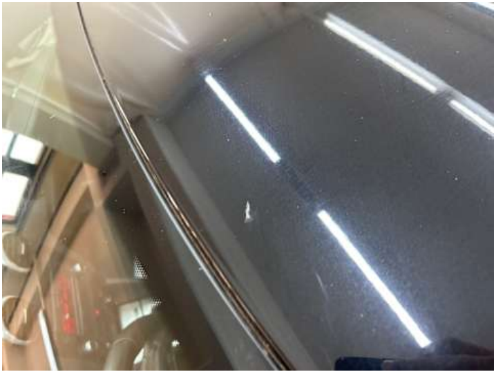
Dach (Lackschaden, Rost)
