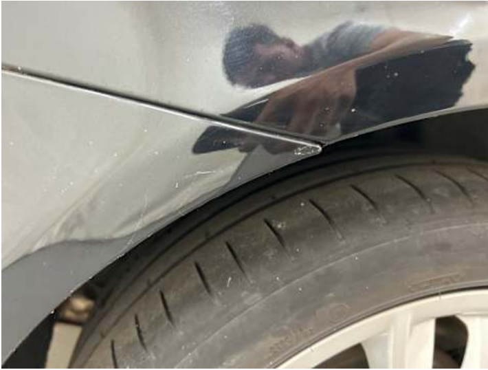
Stoßstange hinten (Lackschaden)
