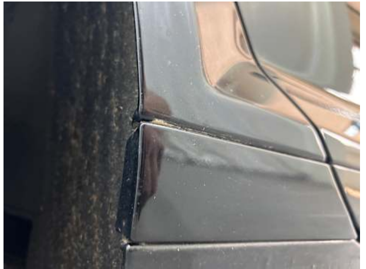
Seitenteil hinten rechts (Rost)
