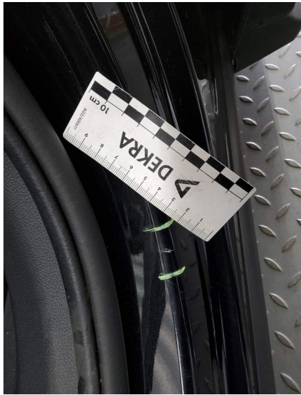
Tür vorne links Einstieg Lackierung, zerkratzt, smart repair (DEKRA)
