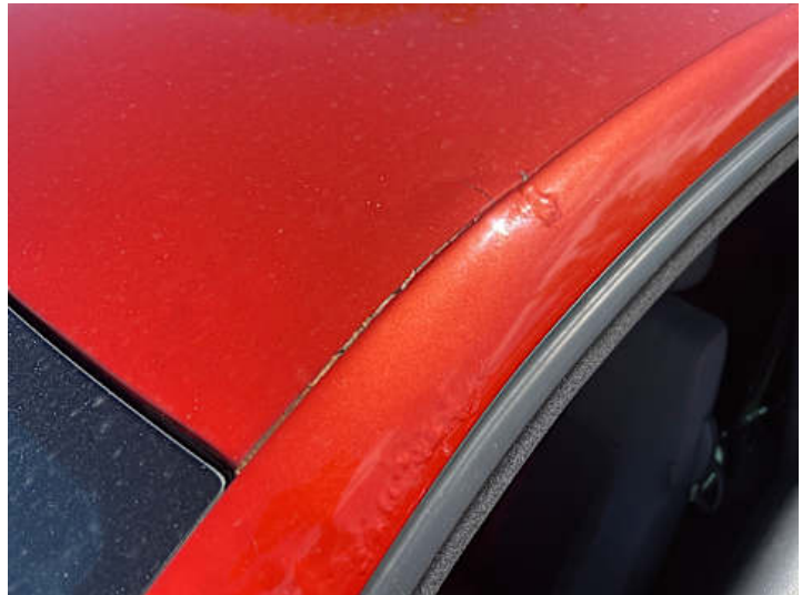
Dach (Rost, Unsachgemäß instand gesetzt)
