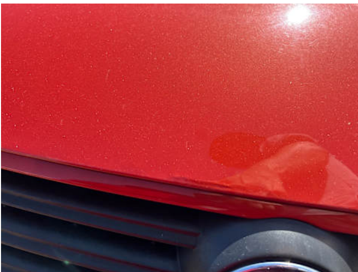
Motorhaube (Rost, Delle)
