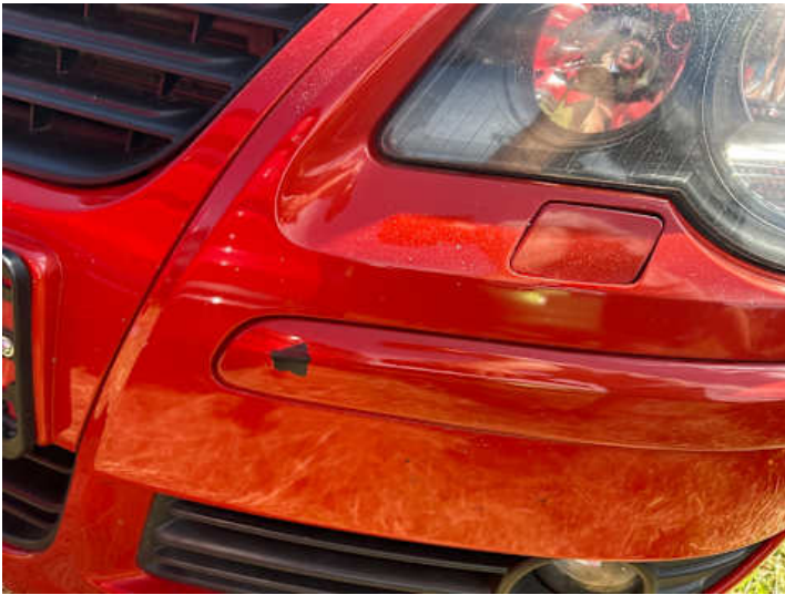
Stoßstange vorne (Riss/Bruch, Spaltmaße ungenau)
