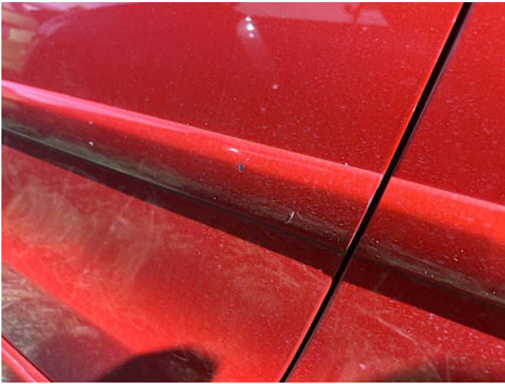
Fahrertür (Rost, Kratzer, Delle)
