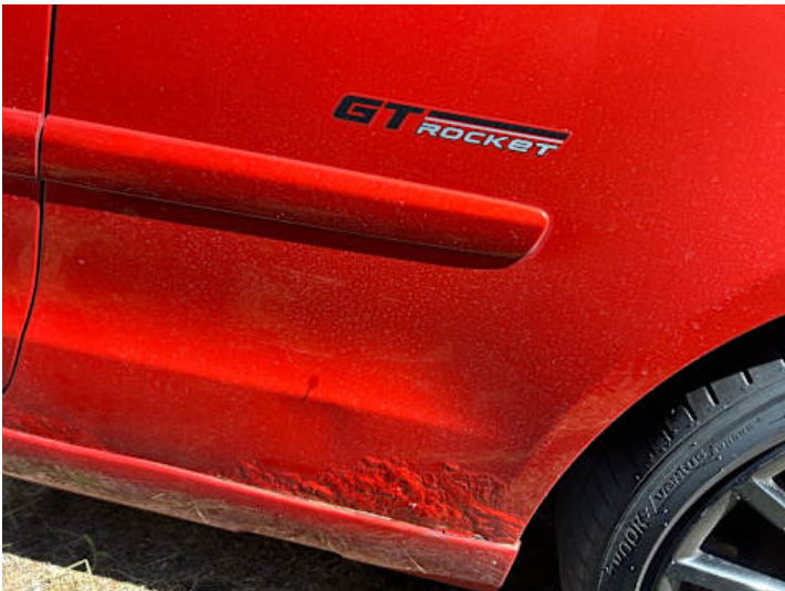
Seitenteil hinten links (Rost)
