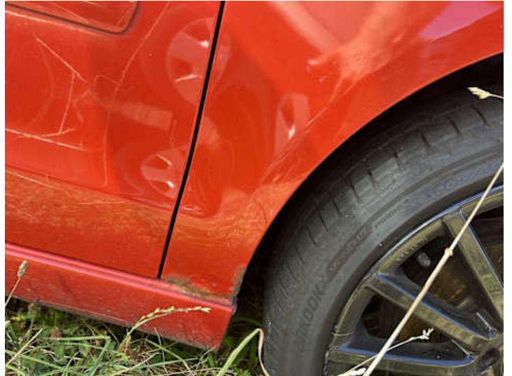
Kotflügel vorne rechts (Rost)
