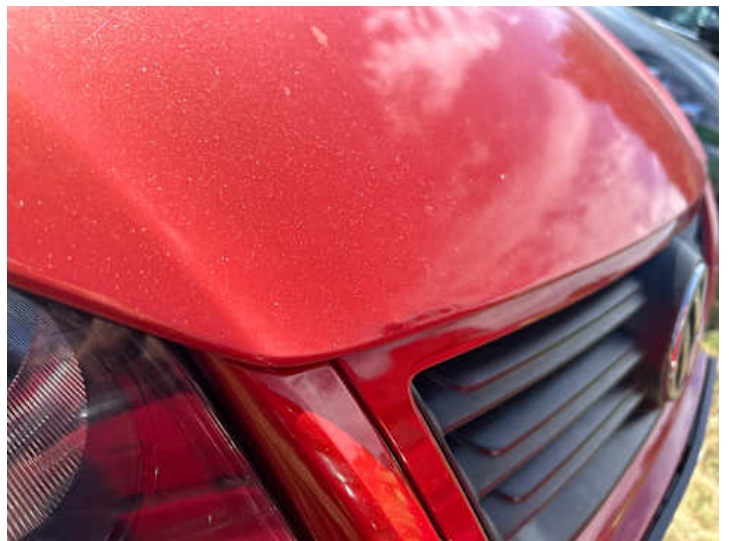
Motorhaube (Rost, Delle)
