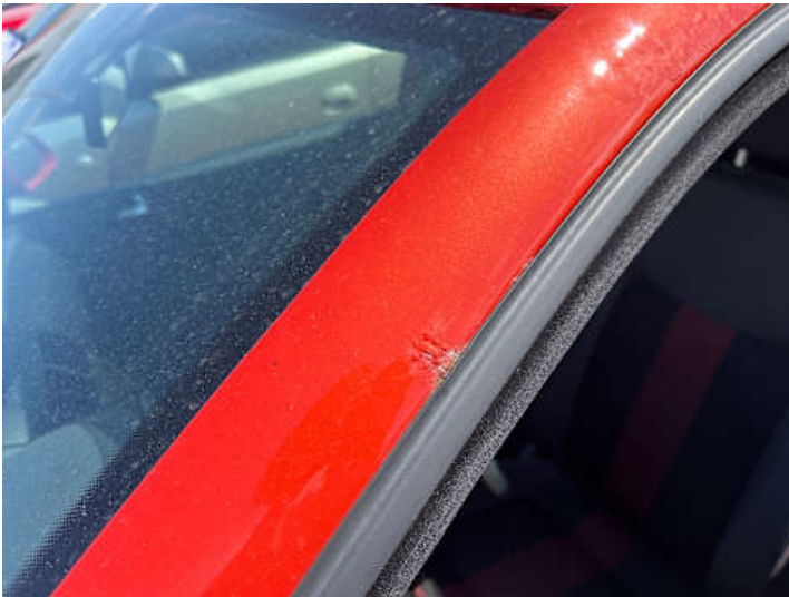
Dach (Rost, Unsachgemäß instand gesetzt)
