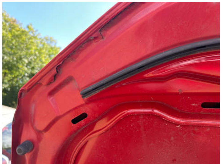
Motorhaube (Rost, Delle)
