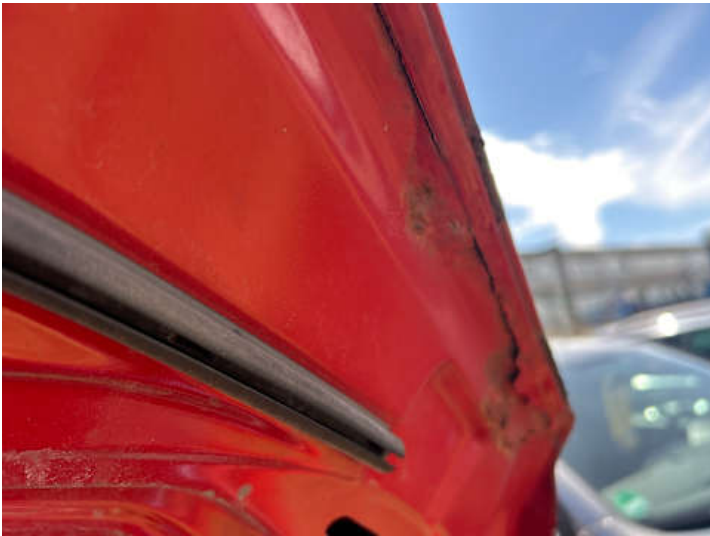
Motorhaube (Rost, Delle)
