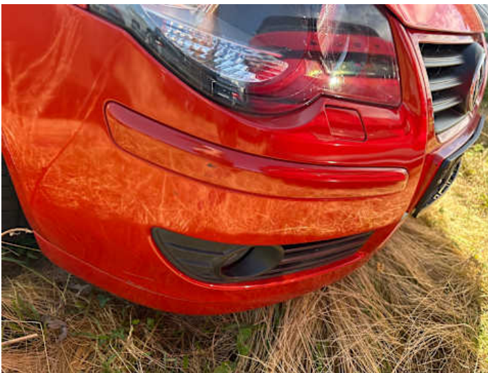
Stoßstange vorne (Riss/Bruch, Spaltmaße ungenau)
