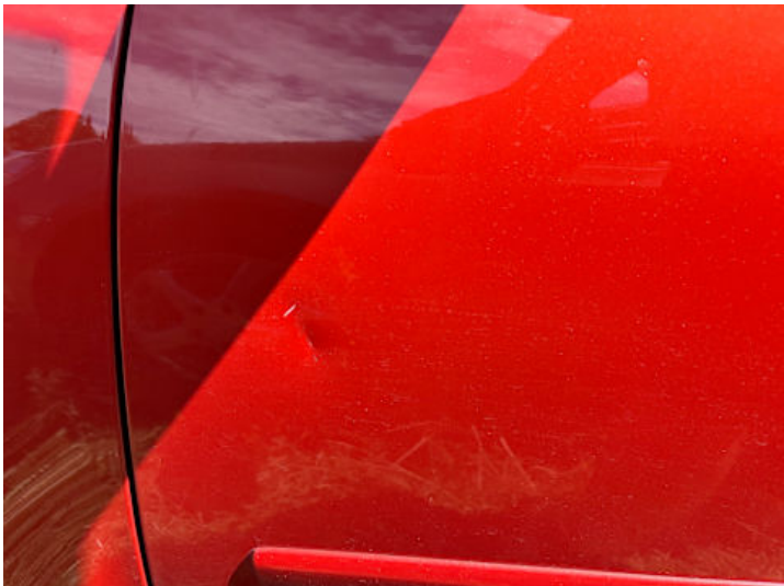
Fahrtür (Rost, Kratzer, Delle)
