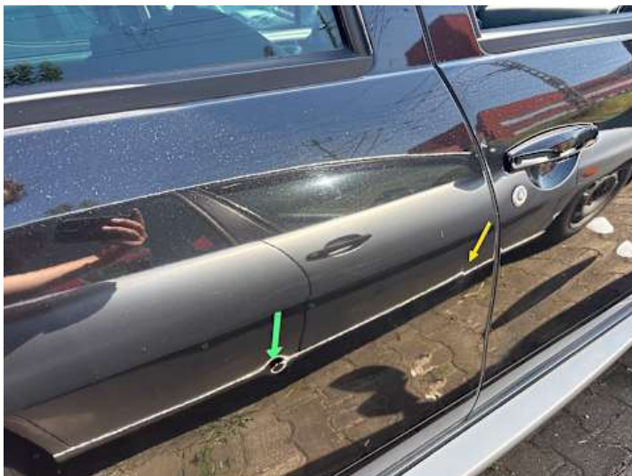
Türe hinten rechts (Delle, Kratzer, Lackschaden)
