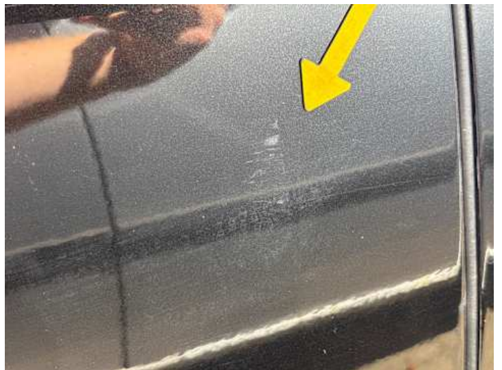
Türe hinten rechts (Delle, Kratzer, Lackschaden)
