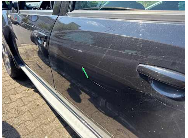
Türe hinten links (Delle)
