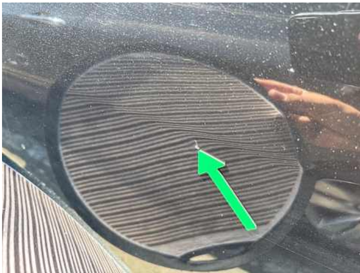
Türe hinten links (Delle)
