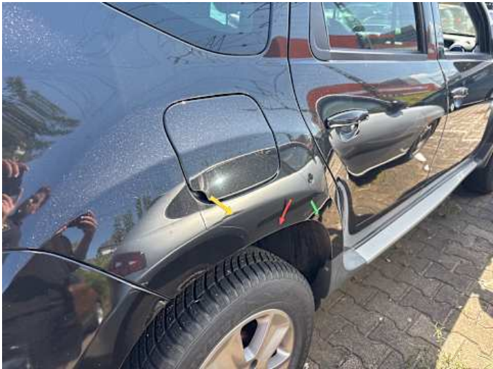
Seitenteil hinten rechts (Delle, Verformung)
