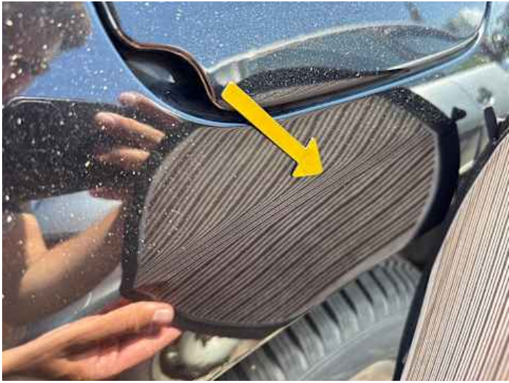
Seitenteil hinten rechts (Delle, Verformung)
