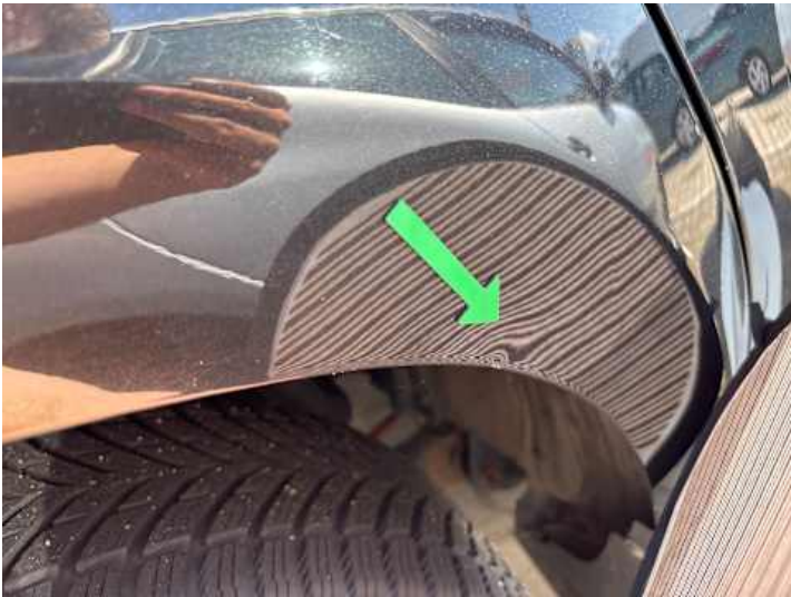
Seitenteil hinten rechts (Delle, Verformung)
