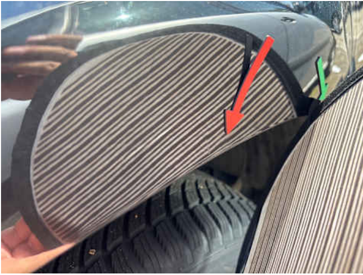
Seitenteil hinten rechts (Delle, Verformung)
