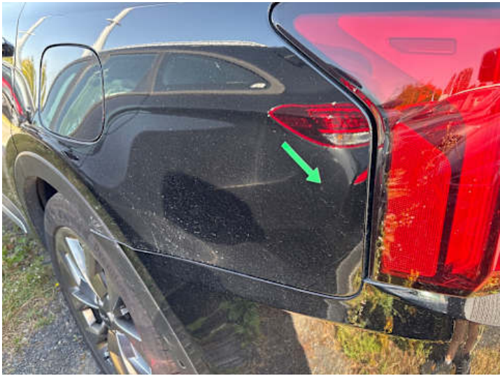
Seitenteil hinten links (Spaltmaße ungenau)
