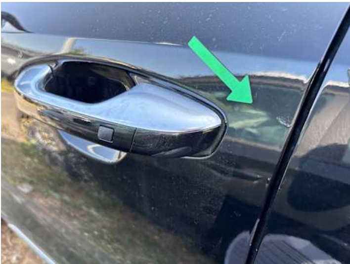
Fahrertür (Unsachgemäß instand gesetzt)
