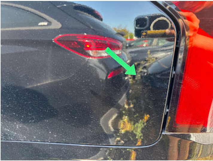
Seitenteil hinten links (Spaltmaße ungenau)
